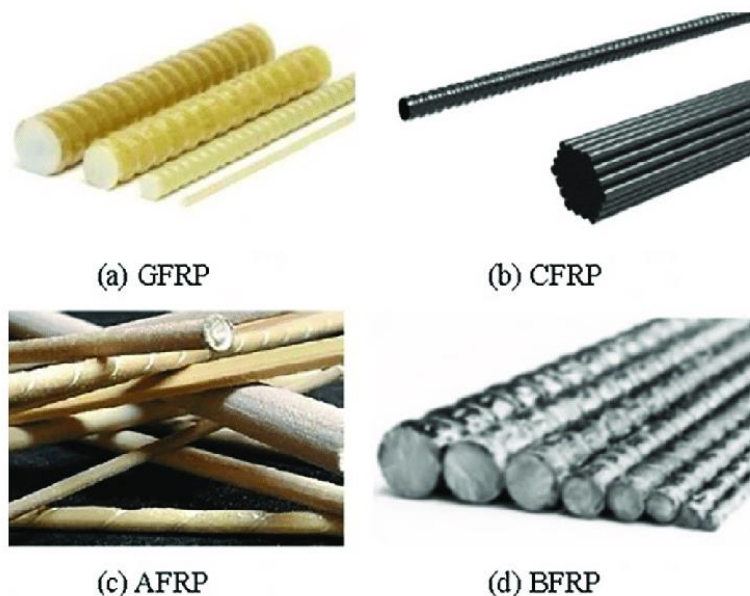
Σχήμα 2.1: Ράβδοι οπλισμού από ινοπλισμένα πολυμερή
