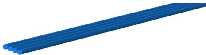
Σχήμα 4.56: Προσομοίωση λωρίδας CFRP με 4 στοιχεία δικτυώματος ( b=16\text{mm} )
