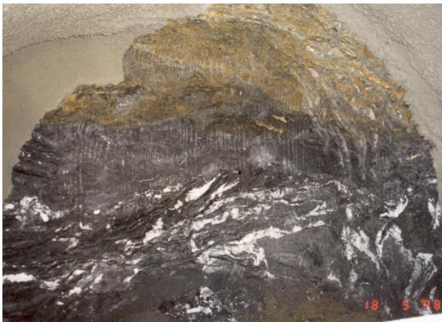
Εικόνα 4-1: Επαφή γκριζοπράσινου μεταψαμμίτη Ανώτερου «Αθηναϊκού Σχιστόλιθου» (άνω μέρος όψης σήραγγας) με μαύρο γκριζο αργιλικό σχιστόλιθο του Κατώτερου «Αθηναϊκού Σχιστόλιθου». Μέτωπο εκσκαφής σήραγγας μονής τροχιάς (~ 6 μ.) – Γραμμή 3, Διασταύρωση «Μοναστηράκι» - «Κεραμικός». (Πηγή: Geological Map Of Athens Metropolitan Area, Attica (Greece): A REVIEW BASED ON ATHENS METRO GROUND INVESTIGATION DATA, K.Boronkay et al., 2021)
