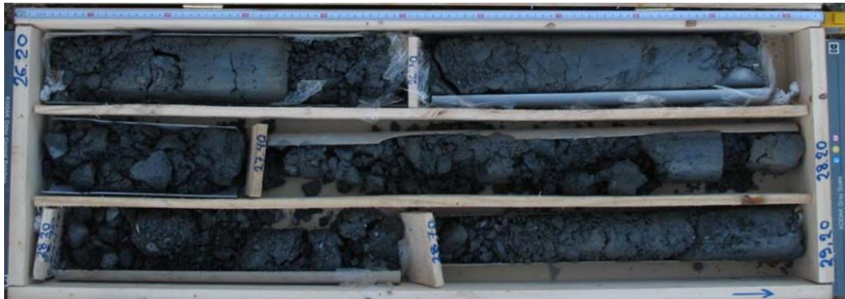
Εικόνα 5-4: Στρώση έντονα κερματισμένου μεταίλυολίθου, GSI=20, γεώτρηση CASN1T
