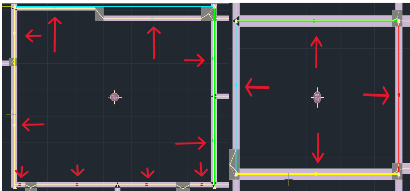
Σχ. 4.12 Απόδοση γραμμών διαρροής και αντιδράσεων ορόφου
