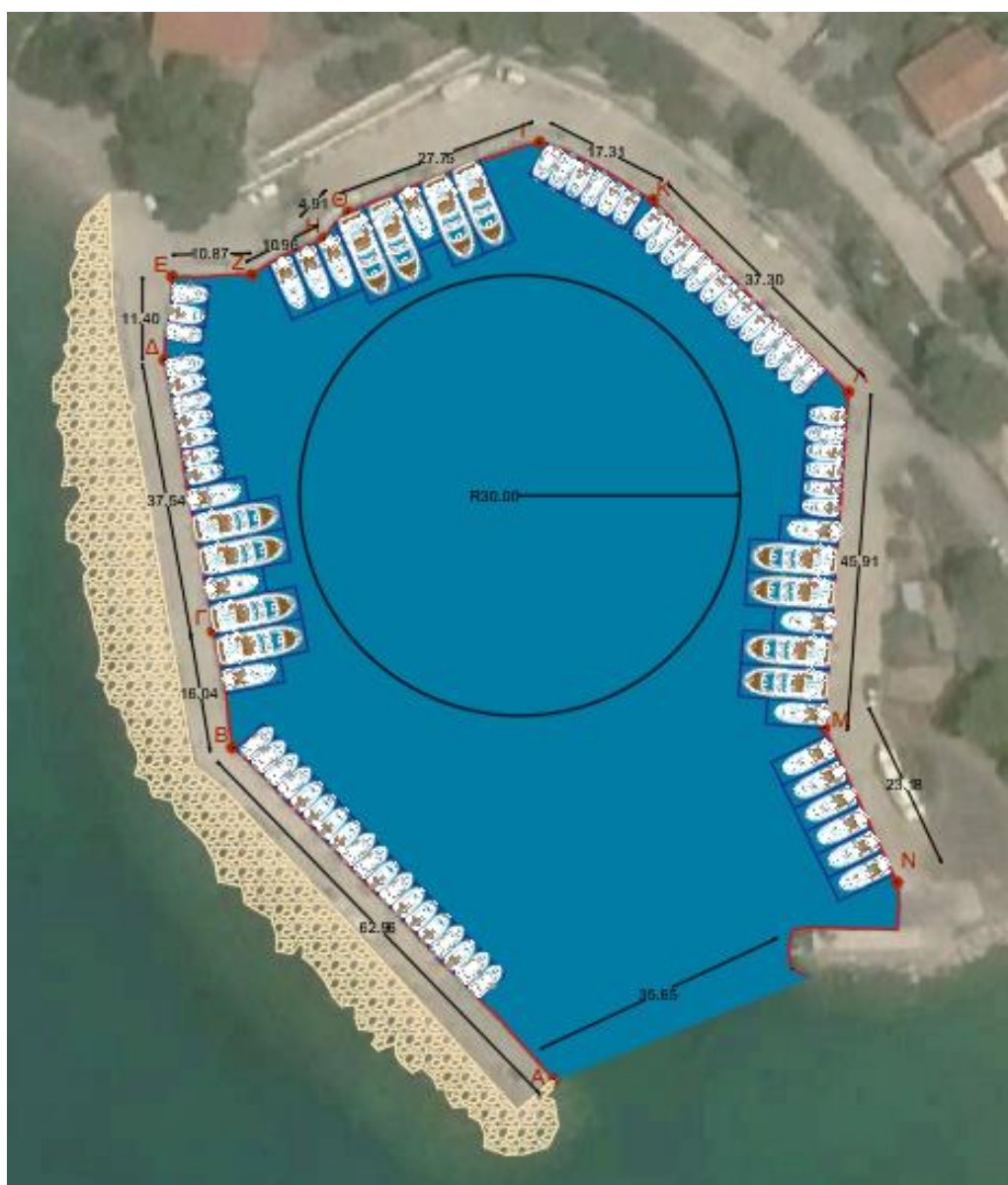
Εικόνα 5.2.11 Κάτοψη αλιευτικού καταφυγίου Πόρτο Γερμενό
