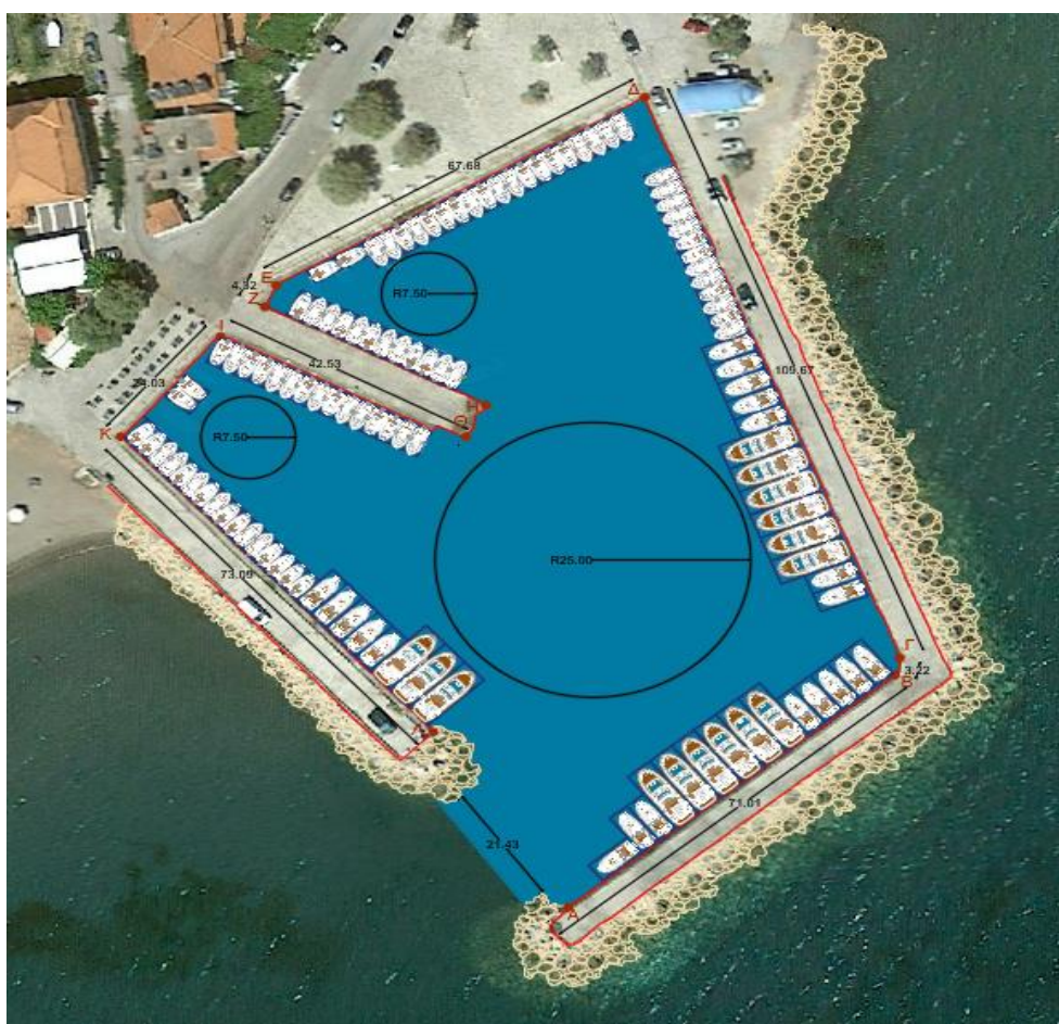
Εικόνα 5.26.5 Κάτοψη αλιευτικού καταφυγίου Χιλιάδους
