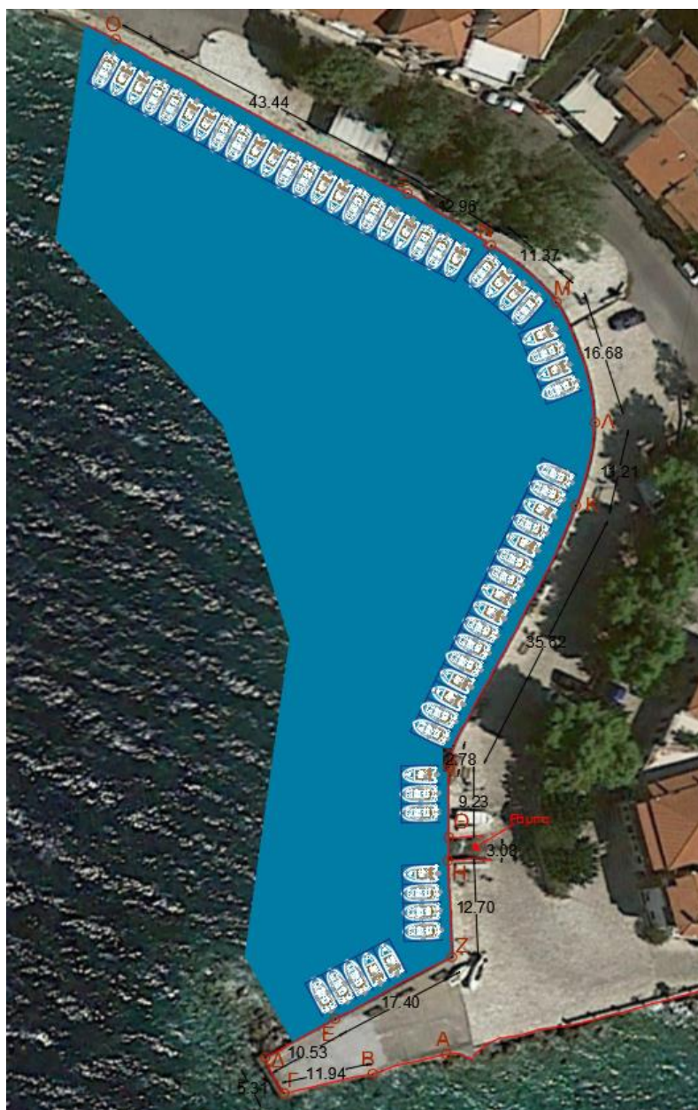
Εικόνα 5.25.5 Κάτοψη αλιευτικού καταφυγίου Μοναστηρακίου
