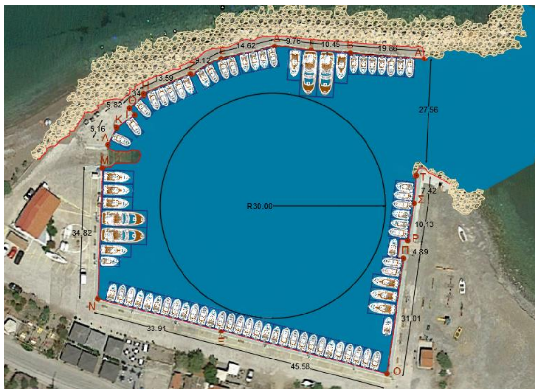
Εικόνα 5.1.7 Κάτοψη αλιευτικού καταφυγίου Αλεποχωρίου
