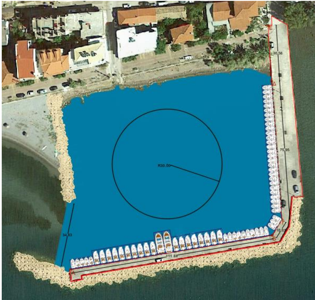
Εικόνα 5.12.5 Κάτοψη αλιευτικού καταφυγίου Κίρρας
