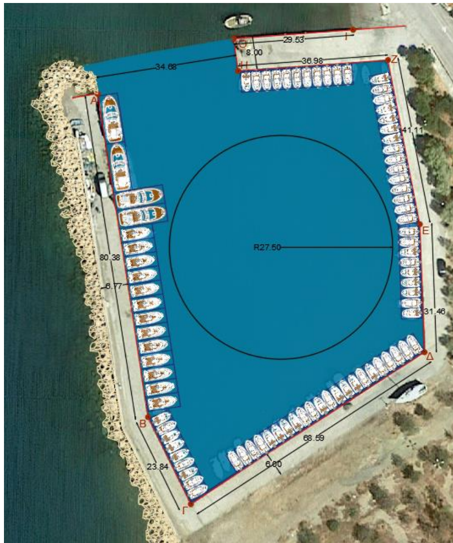
Εικόνα 5.19.3 Κάτοψη αλιευτικού καταφυγίου Ερατεινής
