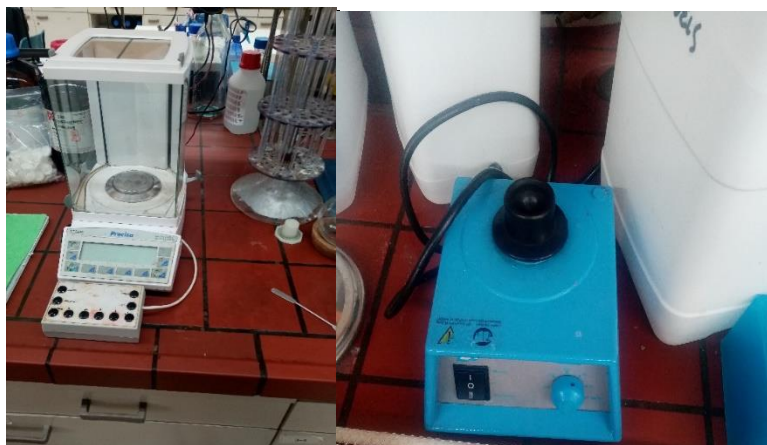
Εικόνες 3.9 και 3.10: Ο ζυγός υψηλής ακρίβειας (αριστερά) και ο αναδευτήρας Vortex (δεξιά).
