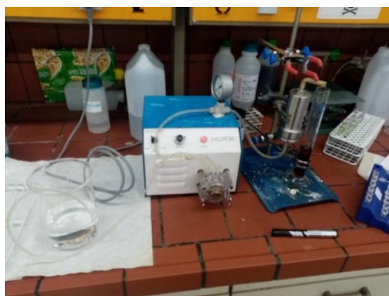
Εικόνα 3.1: Η διάταξη της εκχύλισης ημιδιαλείποντος έργου. Από αριστερά στα δεξιά: η αντλία μαζί με το σύστημα άντλησης (Millipore) και ο εκχυλιστήρας με τους σωλήνες εισόδου και εξόδου του διαλύτη.
