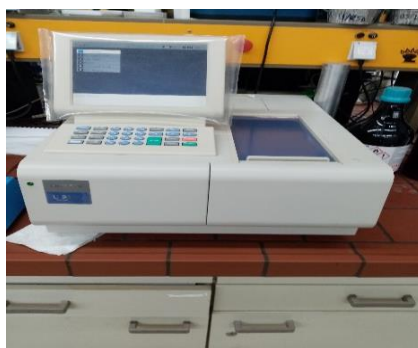
Εικόνα 3.3: Το φασματοφωτόμετρο Hitachi
