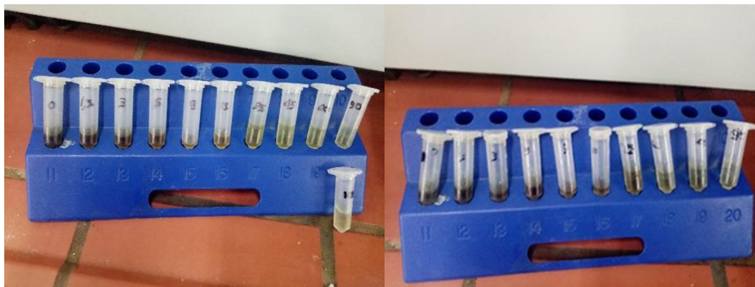
Εικόνες 4.7-4.8: Τα δείγματα από την κινητική μελέτη των πειραμάτων για το λεπτό (αριστερά) και το ξυλώδες κλάσμα (δεξιά). Στα δείγματα φαίνεται η χρωματική μεταβολή με την πάροδο του χρόνου, που αποδεικνύει τη μείωση της συγκέντρωσης σε TPC και λουτεολίνη με το χρόνο.
