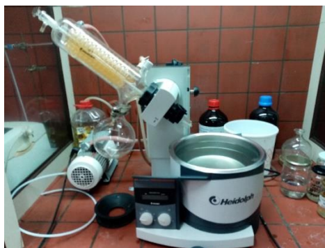
Εικόνα 3.7: Η διάταξη του περιστροφικού εξατμιστήρα
