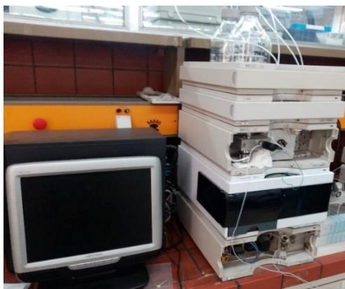
Εικόνα 3.2: Το σύστημα υγρής χρωματογραφίας υψηλής απόδοσης με ανιχνευτή Diode Array (HPLC-DAD), που χρησιμοποιείται για την ανάλυση των εκχυλισμάτων. Αριστερά φαίνεται ο υπολογιστής του προγράμματος και δεξιά η διάταξη της υγρής χρωματογραφίας.
