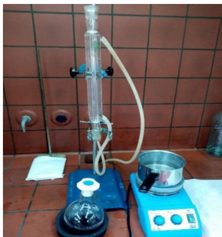
Εικόνα 3.6: Η διάταξη της όξινης υδρόλυσης.
