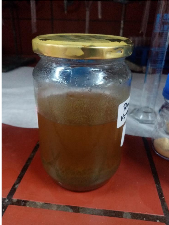
Εικόνα 4.12: Το διάλυμα που προκύπτει μετά την όξινη υδρόλυση, την κατεργασία με απιονισμένο νερό και την ψύξη overnight, όπου διακρίνεται ξεκάθαρα η στερεή φάση (ίζημα πλούσιο σε αγλυκόνες) από την υγρή (διήθημα πλούσιο σε σάκχαρα). Οι δύο φάσεις διαχωρίζονται με διήθηση και η αναδιάλυση της δεύτερης μας δίνει το διήθημα και το αναδιαλυμένο ίζημα της Εικόνας 3.14.
