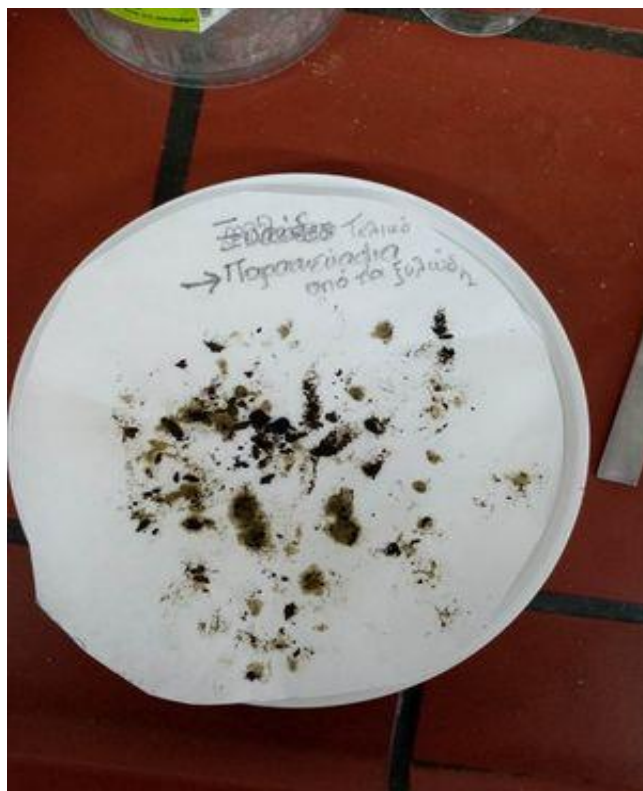
Εικόνα 4.11: Τμήμα του τελικού στερεού παρασκευάσματος μετά την διήθηση του απιονισμένου νερού από το αιώρημα. Το τελικό προϊόν δεν έχει αποχρωματιστεί πλήρως, λόγω της ύπαρξης χλωροφυλλών στα στερεά.
