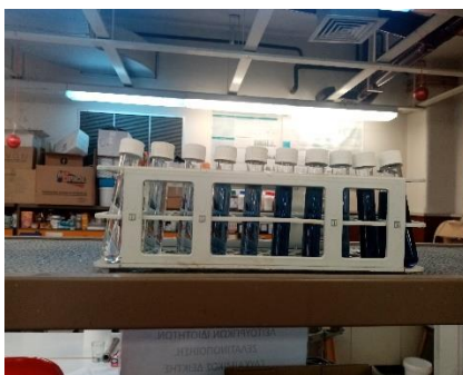
Εικόνα 3.15: Τα δείγματα Folin για την καμπύλη αναφοράς σε ισοδύναμα λουτεολίνης, μετά από επώαση 2 h σε θερμοκρασία περιβάλλοντος.
