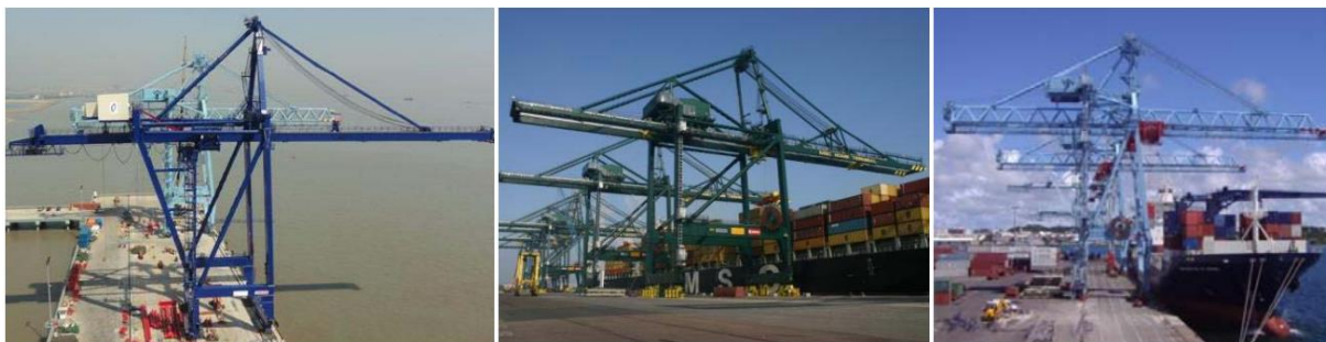
Εικόνα 1-13: Λιμενικοί γερανοί με δοκό κύλισης: monobox (αριστερά), double box (κέντρο) & lattice (δεξιά) (από de Vette, 2011)
