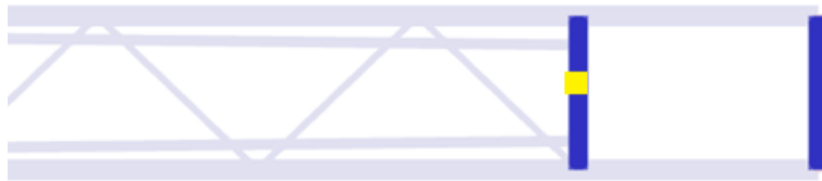
Εικόνα 8-6: Μέλος σύνδεσης ελκυστήρων δοκού-κύλισης (σημείο με κίτρινη σήμανση)
