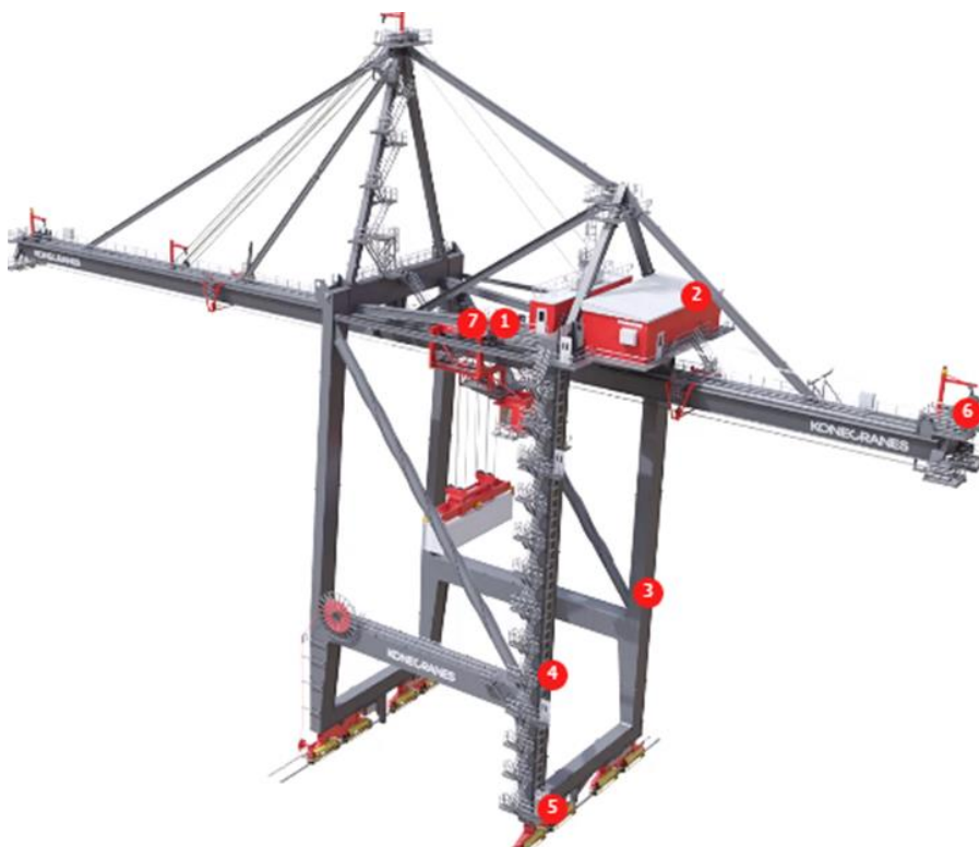
Εικόνα 1-11: Επιμέρους τμήματα ενός τυπικού λιμενικού γερανού (από www.konecranes.com )
