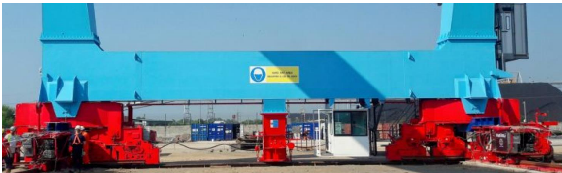
Εικόνα 5-4: Εικόνα μηχανισμού εκτέλεσης μεταφορικής κίνησης τυπικού λιμενικού γερανού (από www.energyfacts.eu )
