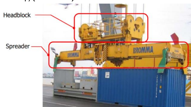
Εικόνα 1-15: Αρπάγη (spreader) & κεφαλή σύνδεσης (headblock) (από de Vette, 2011)
