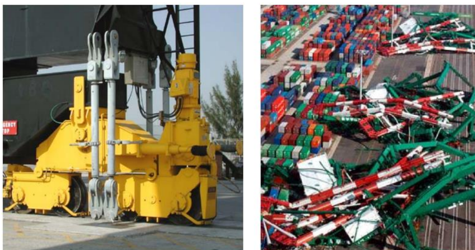
Εικόνα 2-3: Αριστερά σύνδεσμοι ασφαλείας tie-down & δεξιά κατάρρευση γερανού λόγω ανατροπής
