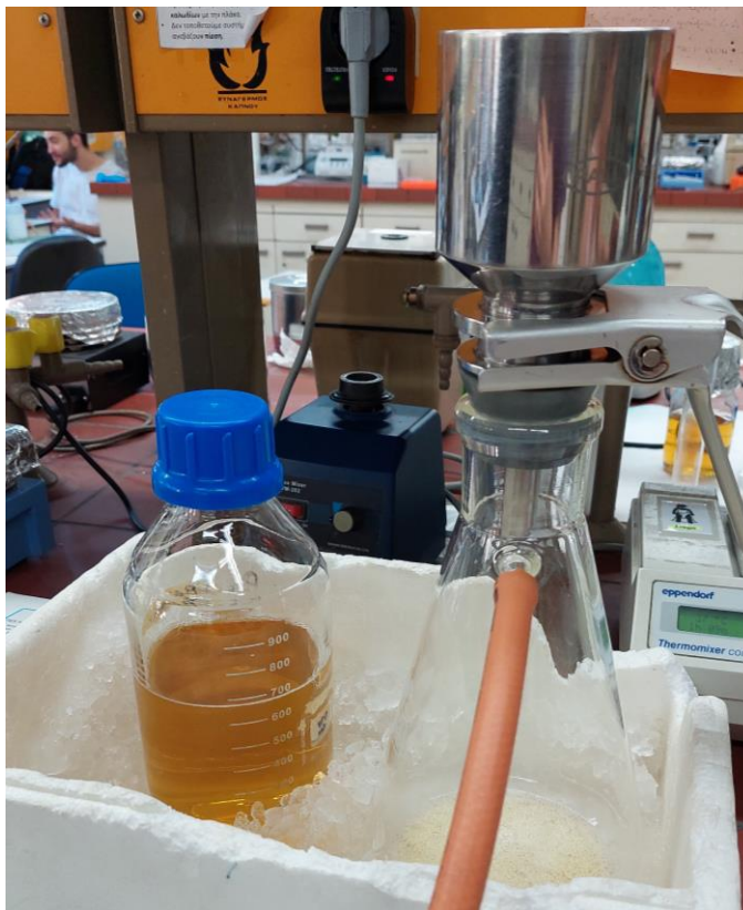
Εικόνα 19: Διήθηση υπό κενό στο υπερκείμενο διάλυμα από την φυγοκέντρηση
