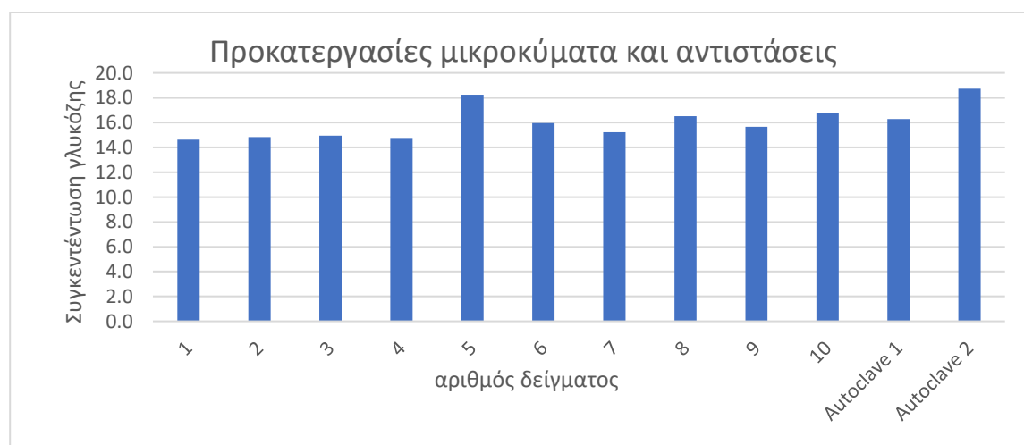
Διάγραμμα 3: Προκατεργασία υλικών με μικροκύματα και με αντιστάσεις και διαλύτες νερό, ακετόνη και οξικό οξύ σε διαφορετικές συγκεντρώσεις και το αποτέλεσμα της υδρόλυσης σε γλυκόζη μετά από 24 ώρες. Τα δείγματα 1-10 είναι προκατεργασμένα με μικροκύματα
