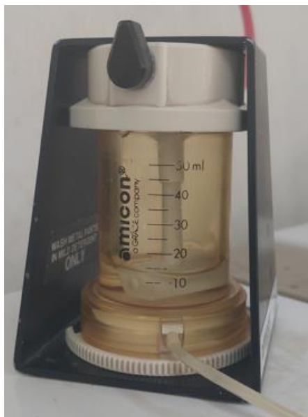
Εικόνα 23: Διάταξη υπερδιήθησης της Amicon Stirred Cell συνολικού όγκού 50 ml με μοριακά φίλτρα 30 kDa
