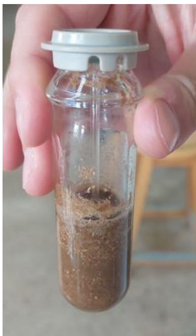
Εικόνα 25: Ειδικό φιαλίδιο (vial) όγκου 30 ml στο οποίο έχουν τοποθετηθεί το υλικό που προκατεργάζονταν και ο διαλύτης
