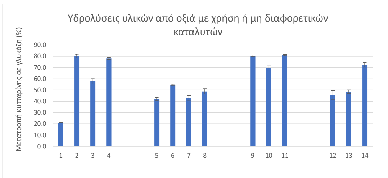
Διάγραμμα 8: Ποσοστιαία μετατροπή κυτταρίνης σε γλυκόζη υλικών από οξιά με τη χρήση ή μη καταλυτών
