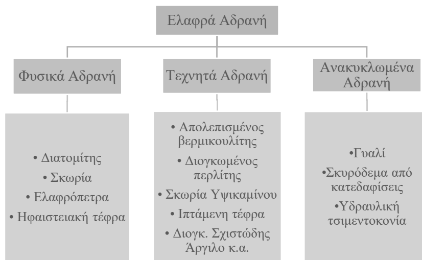
Εικ. 2-6: Κατηγορίες Ελαφρών Αδρανών (LightWeight Aggregate LWA)
