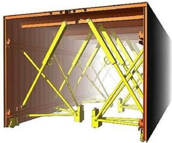
Εικ. 1-4: Tunnel formwork, πηγή: (The Constructor, 2023)
