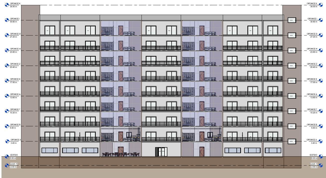
Εικ. 3-2: Νότια όψη κτιρίου (Revit® Autodesk)
