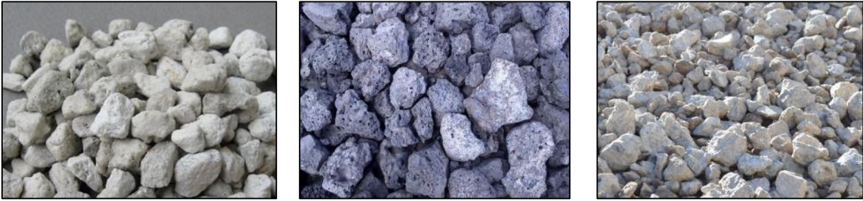
Εικ. 2-5: Ελαφρά αδρανή: α) Κίσσηρη, β) Σκωρία Υψικαμίνου, γ) Ανακυκλωμένο Σκυρόδεμα
