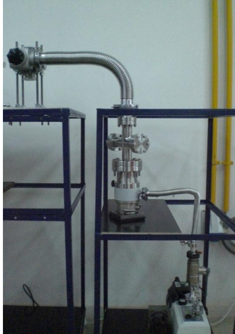
Εικόνα 42: Εγκατάσταση και συνδεσμολογία τουρμπομοριακής αντλίας
