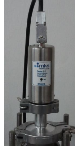
Μετρητής πίεσης (transducer) στο πάνω μέρος του σταυρού
