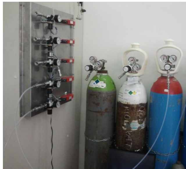
Πλαστικό σωληνάκι στη βάνα εισαγωγής αερίου, το οποίο εισάγεται ως αποτέλεσμα ενός συστήματος ανάμειξης αερίων
