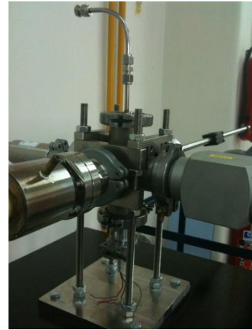
Κόλληση κάτω πλευράς αντάπτορα
