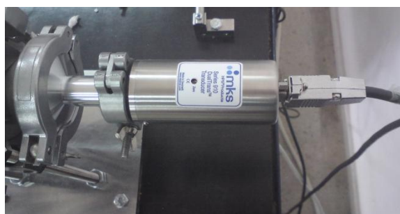
Συνδεσμολογία μετρητή πίεσης
