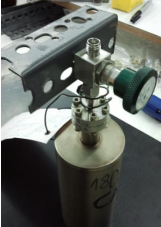
Φιάλη O_{18} με βάνα βιδωμένη σε μεταλλική επιφάνεια
