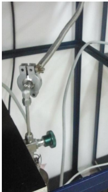
Εικόνα 46: Εγκατάσταση φιάλης O_{18} (Oxygen bottle)
