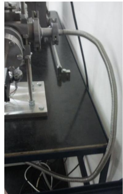
Μετρητής πίεσης (transducer) στο πάνω μέρος του σταυρού
