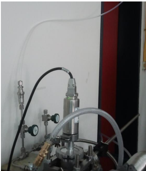
Πλαστικό σωληνάκι στη βάνα εισαγωγής αερίου, το οποίο εισάγεται ως αποτέλεσμα ενός συστήματος ανάμειξης αερίων
