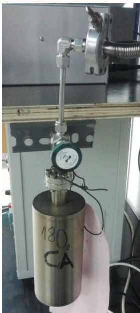
Φιάλη O_{18} με βάνα βιδωμένη σε μεταλλική επιφάνεια
