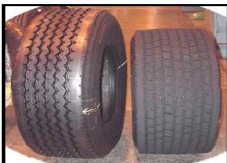
Εικόνα 3.13: Σύγκριση μεγέθους των πρώτων συμβατικών πλατύπελμων μονών ελαστικών με τα νέας γενιάς πλατύπελμων μονών ελαστικών (Al - Qadi, et al., 2009)
