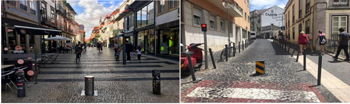
Εικόνα 5:Αυτόματες ανυψωτικές κολώνες στο Πόρτο και στη Λισαβόνα (Πηγή: Valenca et al.)
