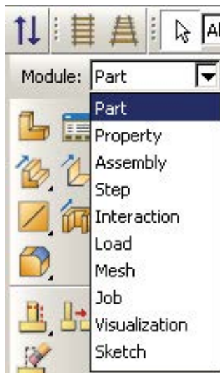
Εικόνα 3.2.2: Τα τμήματα που αποτελούν τα λειτουργικά στοιχεία του Abaqus.
