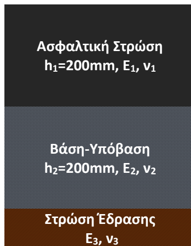
Εικόνα 3.2: Διατομή πειραματικού οδοστρώματος
