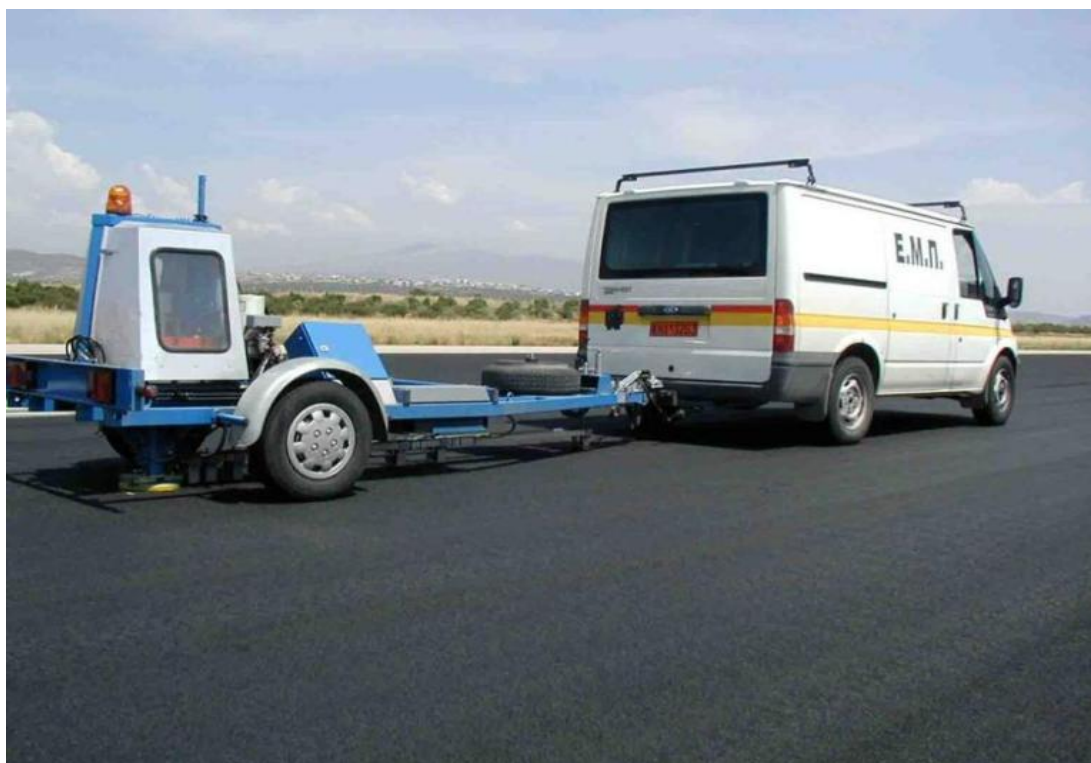
Εικόνα 2.1: Το παραμορφωσίμετρο πίπτοντος βάρους-FWD του Εργαστηρίου Οδοστρωμάτων του Ε.Μ.Π.
