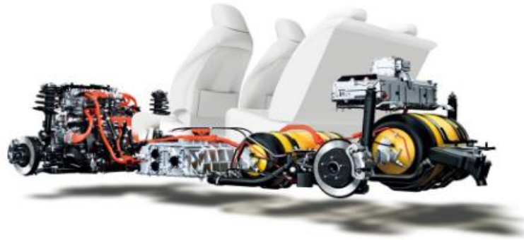
Εικόνα 3. Σύστημα κυψελών καυσίμου στο πρωτότυπο Toyota Mirai
