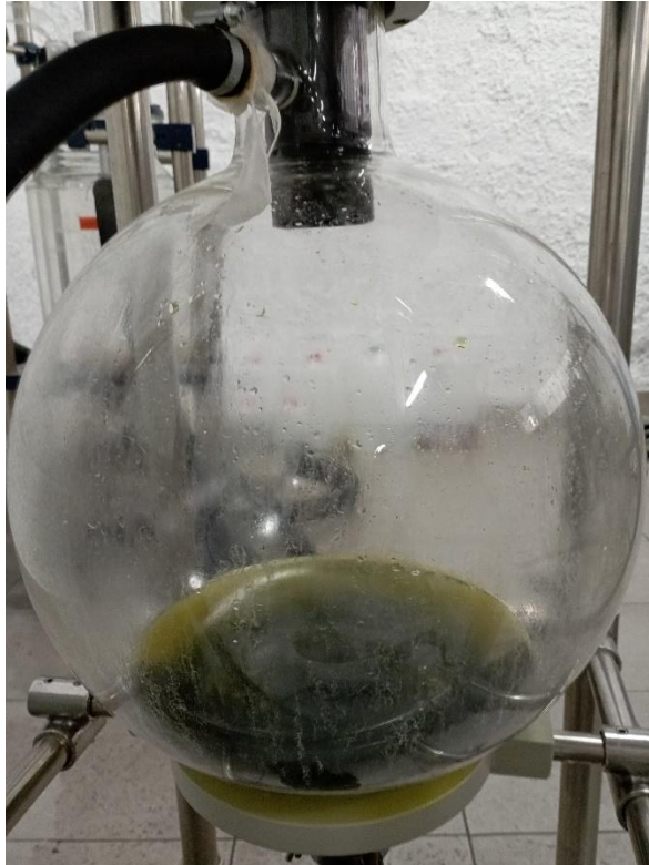
Εικόνα 43. Το διήθημα, στο οποίο εμπεριέχεται το μεγαλύτερο ποσοστό PGMs.
