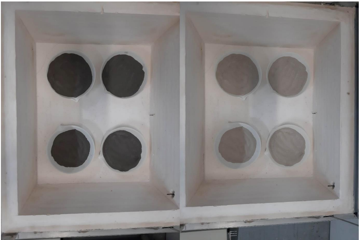
Εικόνα 28. Τα δείγματα πριν και μετά την πύρωση (750 °C για 5 h).
