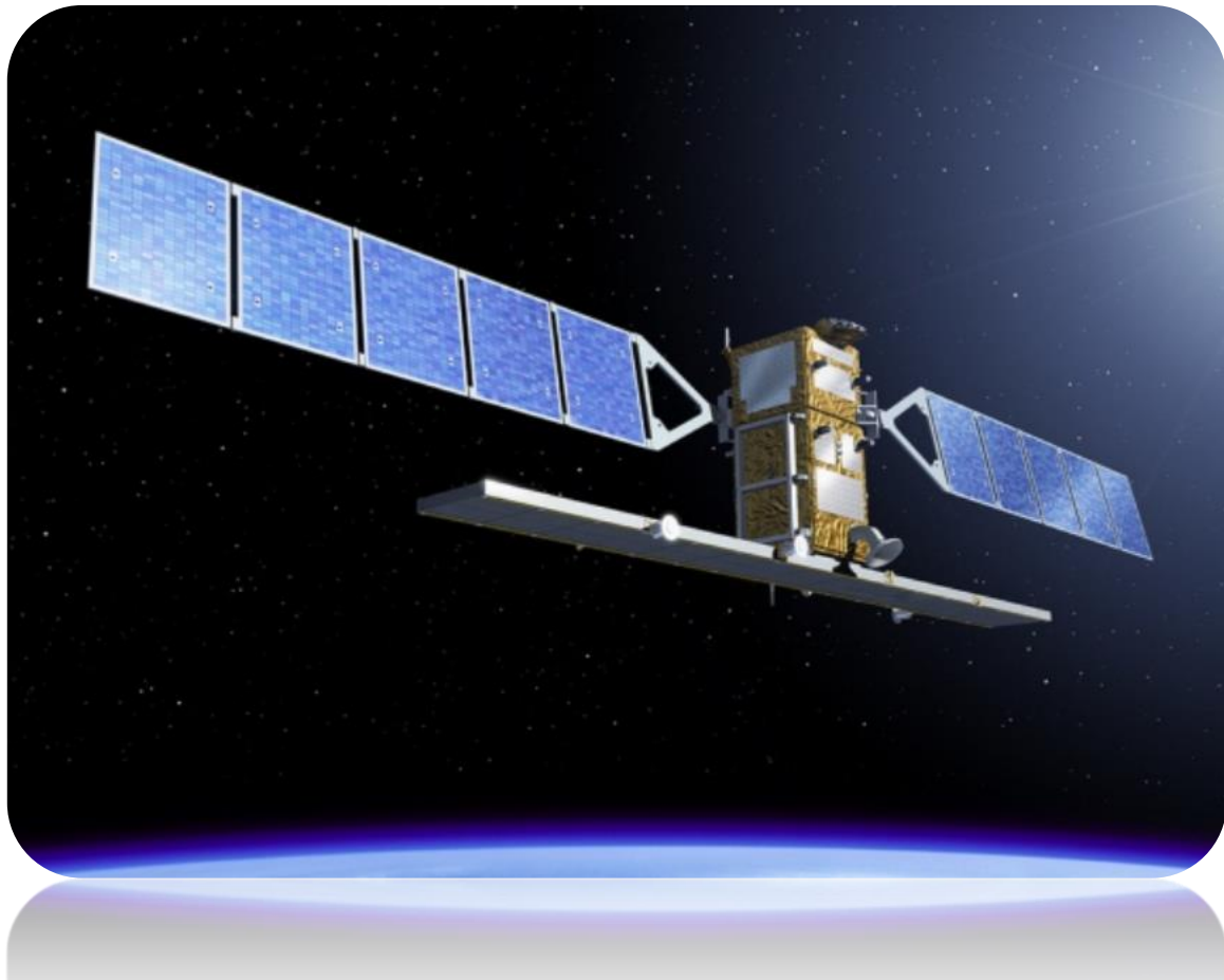
Εικόνα 13: Ο δορυφόρος Sentinel-1 (Πηγή: https://sentinels.copernicus.eu/web/sentinel/missions/sentinel-1 )
