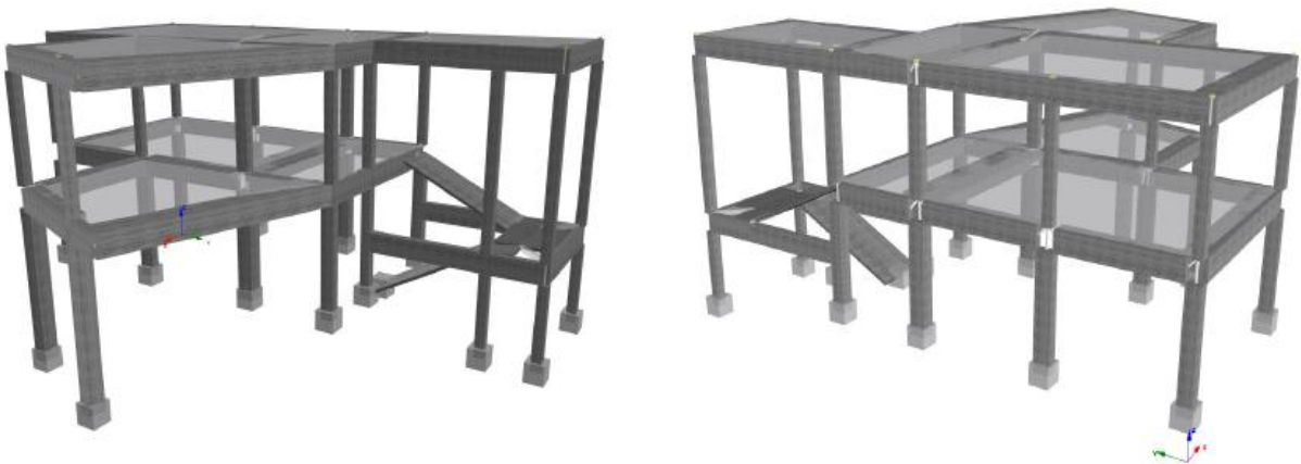
Εικόνα 14: Τρισδιάστατη απεικόνιση κτιρίου Γ μέσω προγράμματος SeismoStruct
