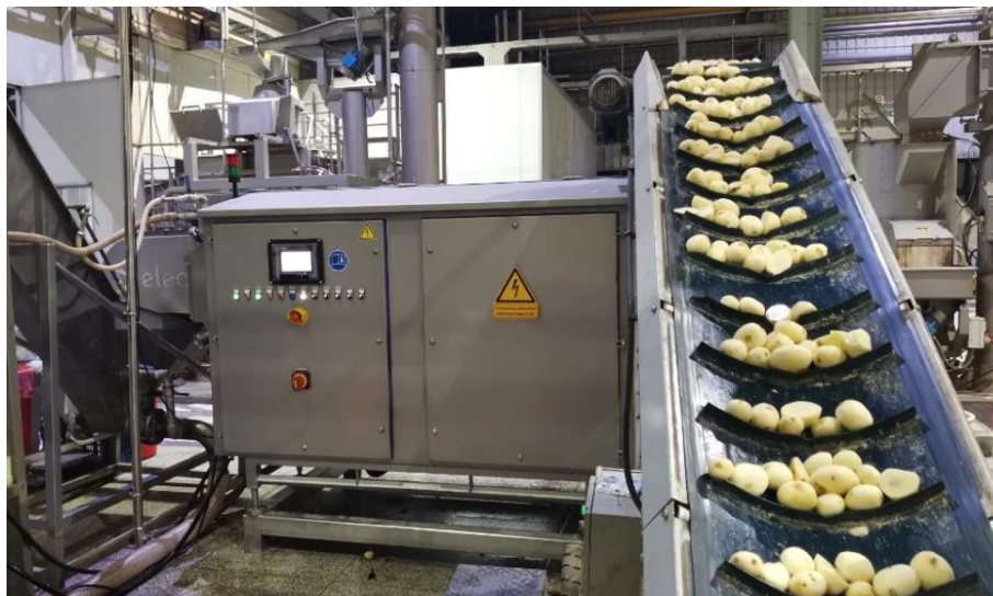
Εικόνα 4.5. Εφαρμογή παλμικών ηλεκτρικών πεδίων στη βιομηχανία παραγωγής προϊόντων πατάτας ( https://elea-technology.com/pef-advantage-belt/ , 2023)
