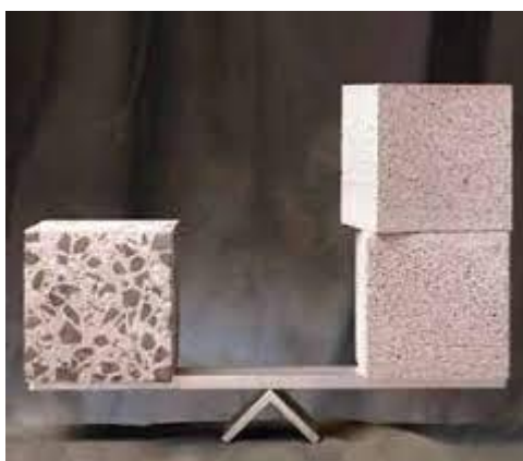
Εικόνα 3: Ενδεικτική σύγκριση βάρους NC και LWC
