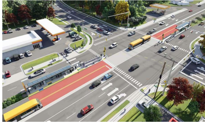
Εικόνα 10: Παράδειγμα διαμόρφωσης συστήματος BRT στο Raleigh – Πηγή: https://raleighnc.gov/transportation/services/what-bus-rapid-transit-brt
