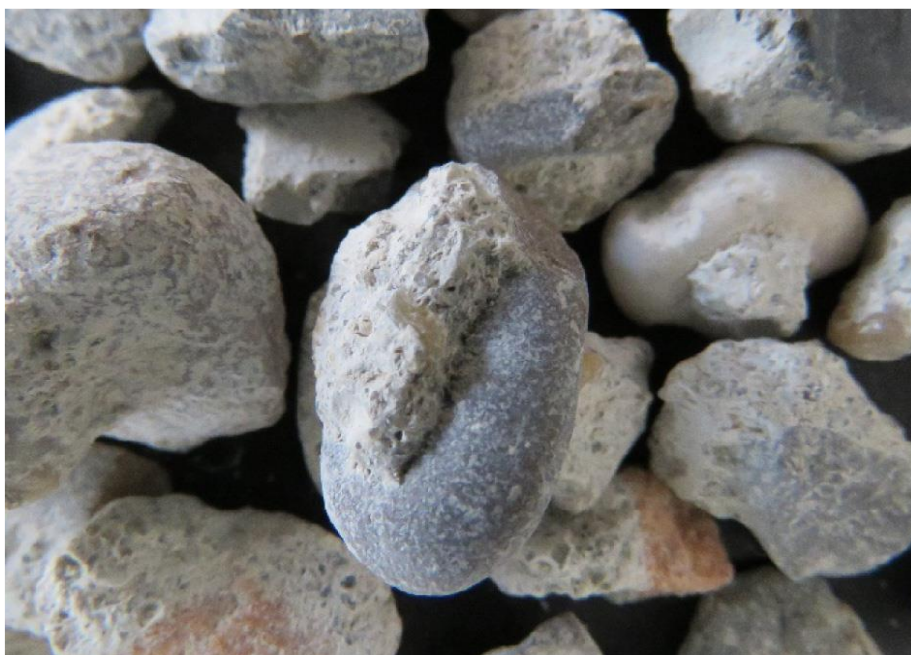
Εικόνα 4.2: Χαρακτηριστικό παράδειγμα άποψης ανακυκλωμένου αδρανούς, με επικολλημένο κονίαμα Πηγή: (Bonifazi, Giuseppe; Palmieri, Roberta; Serranti, Silvia;, 2018)
