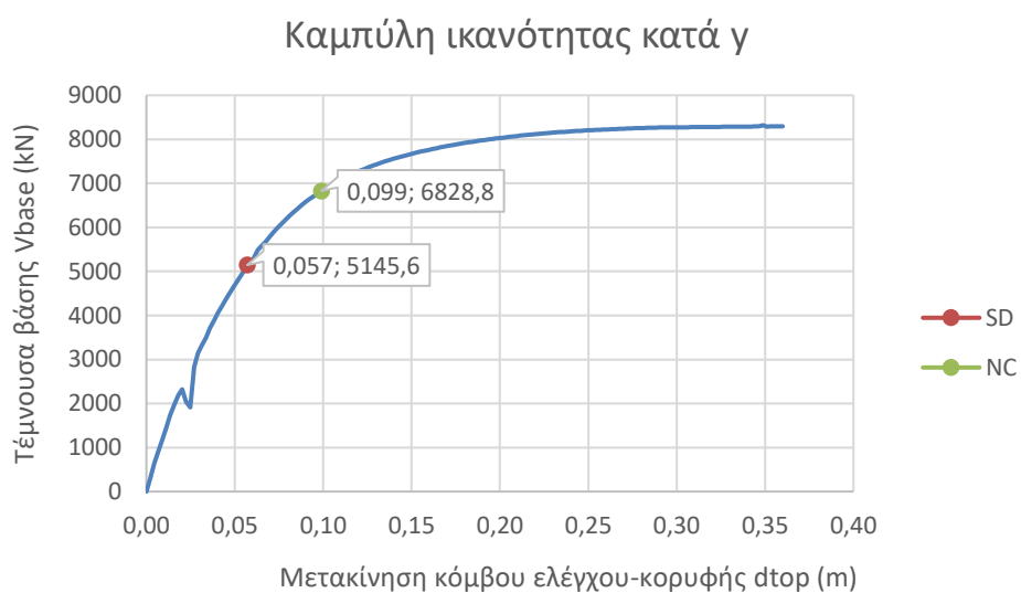
Σχήμα 3.13: Καμπύλη ικανότητας κατά τη διεύθυνση y, κατά ΕΚ8
