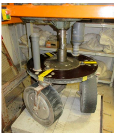
Εικόνα 3.6: Στίλβωνας πλακών (Gierasimiuk, et al., 2021)
