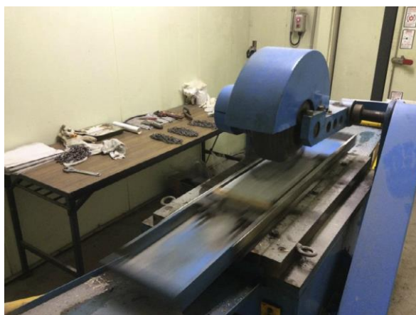
Εικόνα 3.14: Συσκευή δοκιμής raveling (Yoshitake, et al., 2016)
