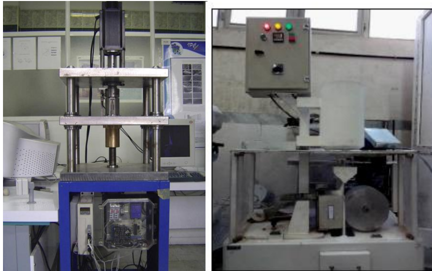
Εικόνα 3.9: Η συσκευή δοκιμής τριβής (αριστερά) και η χρησιμοποιούμενη συσκευή απότριψης (δεξιά) (Jalalkamali, et al., 2021)
