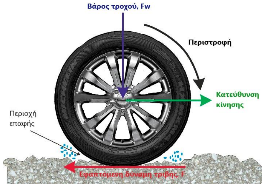
Εικόνα 2.2: Τυπικό σκαρίφημα των δυνάμεων που δρουν σε έναν περιστρεφόμενο τροχό
