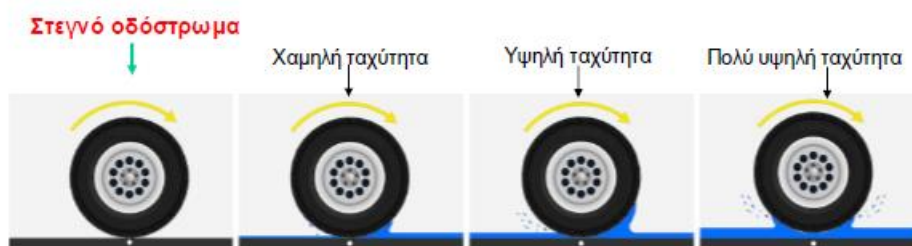
Εικόνα 2.9: Φιλμ νερού στο οδόστρωμα (Λοΐζος & Πλατή, 2021)
