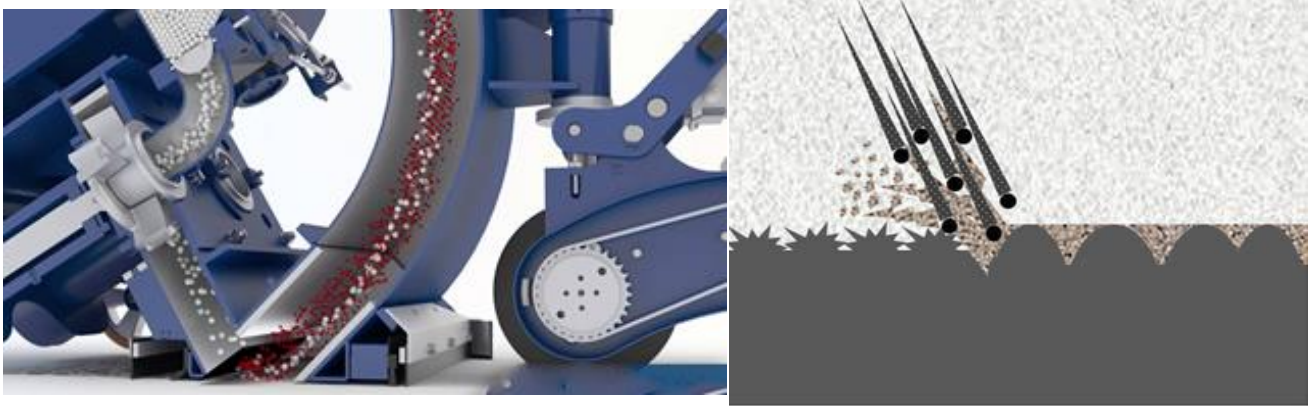
Εικόνα 4.17: Λειτουργία μεθόδου σφαιριδιοβολής
