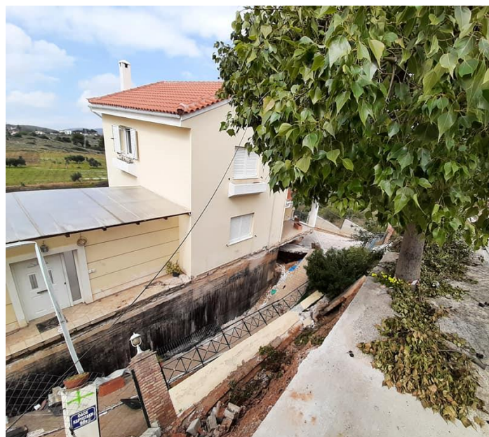
Εικόνα 1.8: Άποψη της κύριας κατακρήμνισης της κατολίθησης όπως αυτή φαίνεται από την στέψη της
