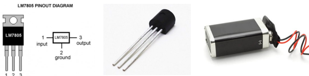
Εικόνα 17: Από αριστερά προς τα δεξιά: (1) LM7805 (2) LM2936 (3) 9V Battery
