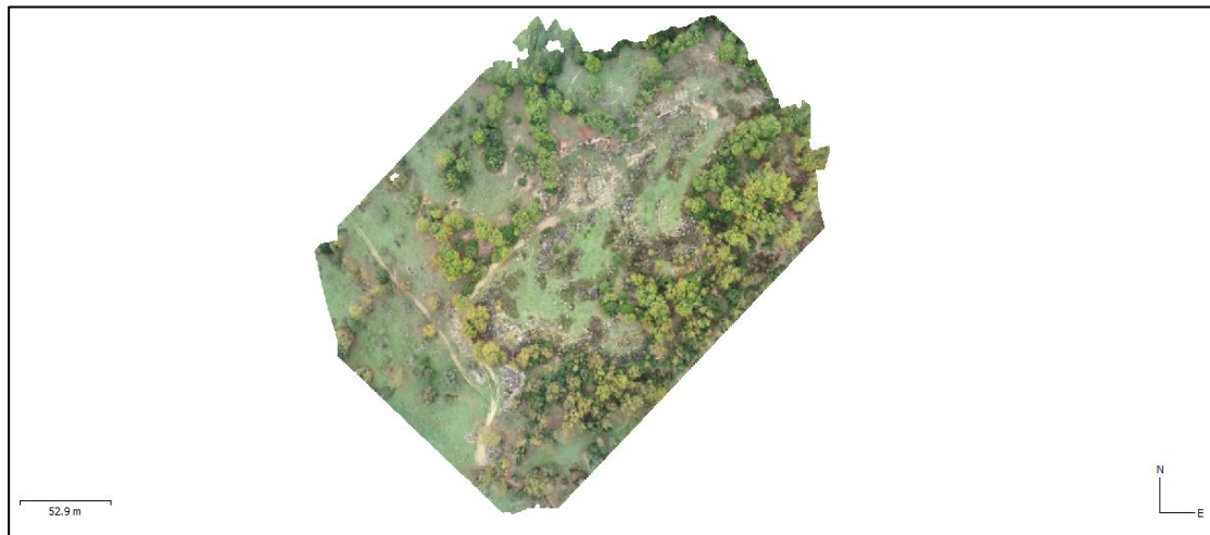
Εικόνα 4-22 Το orthomosaic για την γεωαναφορά της κάτοψης του σημείου ενδιαφέροντος των Αναργύρων
