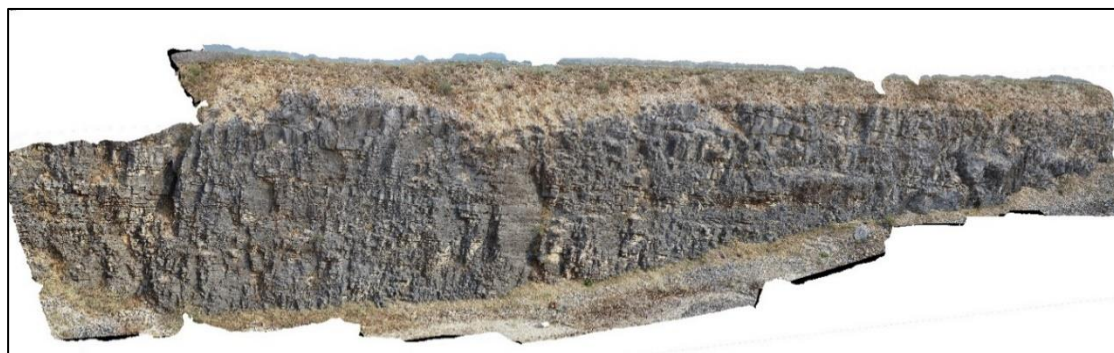
Εικόνα 4-13: Το tiled model για την αναπαράσταση των διακλάσεων του μετώπου scanline 1.1
