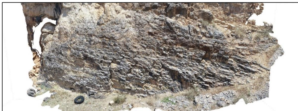
Εικόνα 4-14: Το tiled model για την αναπαράσταση των διακλάσεων του μετώπου scanline 1.2
