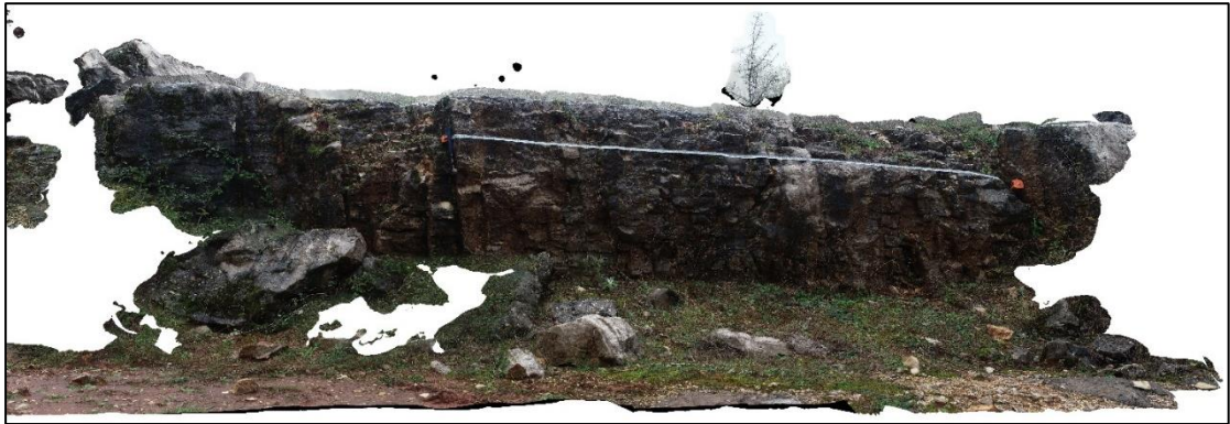
Εικόνα 4-19: Το tiled model για την αναπαράσταση των διακλάσεων του μετώπου scanline 2.2
