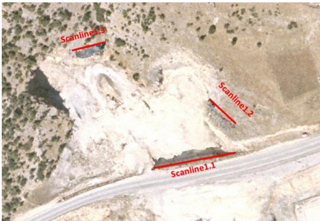
Εικόνα 4-32: Τα αντίστοιχα μέτωπα γεωαναφερόμενα στο χώρο του λατομείου
