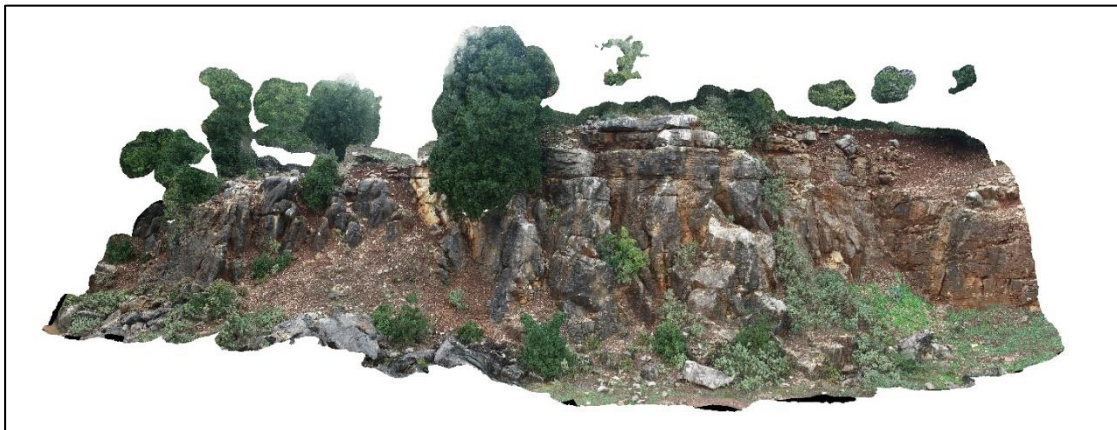
Εικόνα 4-20: Το tiled model για την αναπαράσταση των διακλάσεων του μετώπου scanline 2.3
