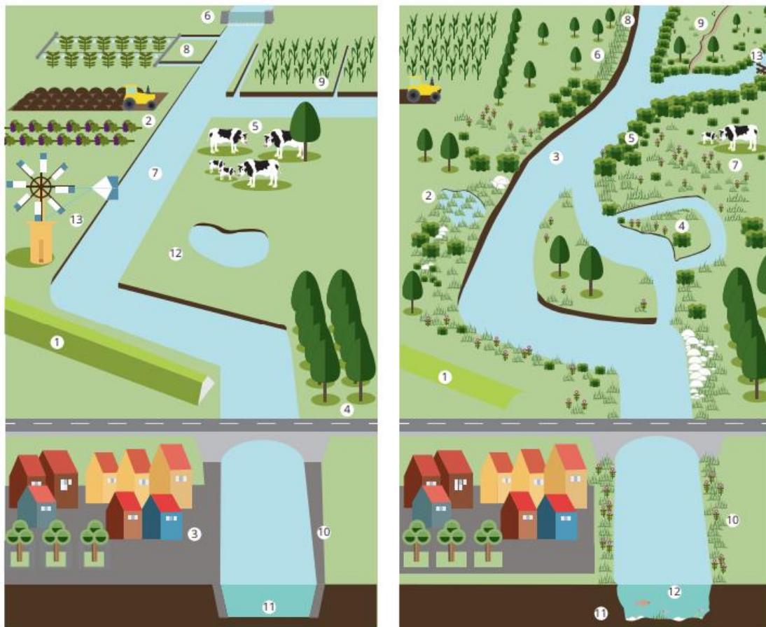
Διάγραμμα 7: Παραδείγματα μέτρων υδρομορφολογικής αποκατάστασης των πλημμυρικών πεδίων (ΕΕΑ, 2019)
