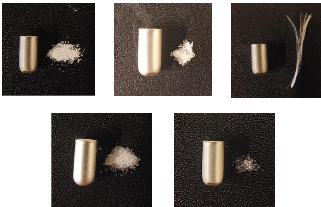
Εικόνα 9: Πολυμερή δίπλα στο κύπελλο πυρόλυσης Eco-cup LF (4mm x 8mm)
