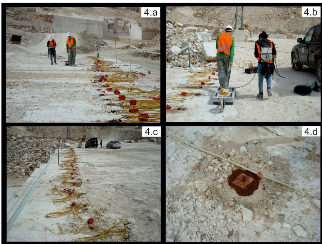
Εικόνα 11: 4a: GPR που πραγματοποιήθηκε σε μαρμάρινο πάγκο. 4b: Κεραία 250 MHz στη τράπεζα. 4c: Θέση του ERI στον πρωτογενή πάγκο 4d: Ηλεκτρόδιο Πηλού και Χαλκού.
