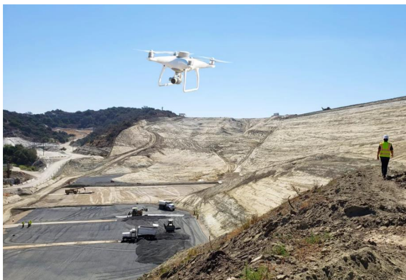
Εικόνα 1: Χρήση μη επανδρωμένων αεροσκαφών στη φωτογραμμετρία για τρισδιάστατες έρευνες. [propelleraero.com]
