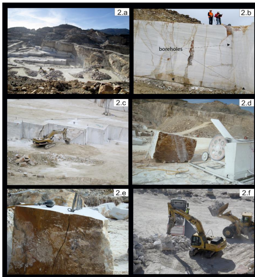
Εικόνα 9: 2a.: Επισκόπηση λατομείο Μαρμάρου στην Ισπανία, περιοχή Mascael. 2b: Λεπτομέρειες για τις 3 κάθετες οπές που οριοθετούν τον όγκο. 2c: Κοπή τριγώνων τεμαχίων με σύρμα με διαμάντια παρουσία εκσκαφέα. 2d: Τετραγωνισμός μπλοκ. 2e: Τετραγωνισμός μπλοκ με τρυπάνι και σφήνες κατά μήκος ρωγμής στο πέτρωμα. 2f: Εκσκαφείας με υδραυλικό σφυρί.
