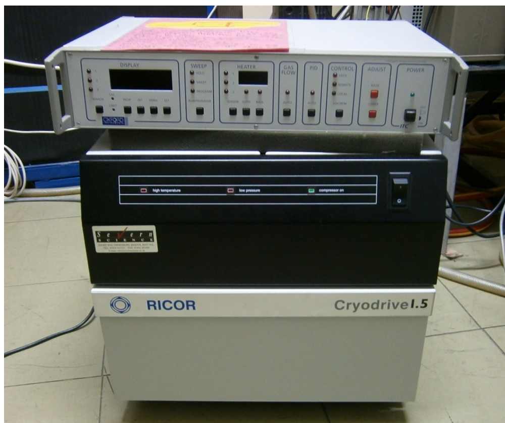
Εικόνα 4.3. Κρυοστάτης κλειστού κυκλώματος ηλίου (closed-cycle He-cryostat)
