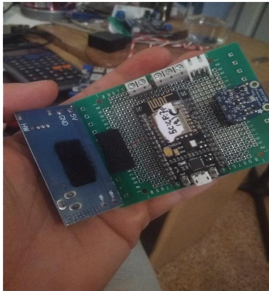
Εικόνα 4.17 - Χρήση Velcro για στερέωση του μετασχηματιστή
