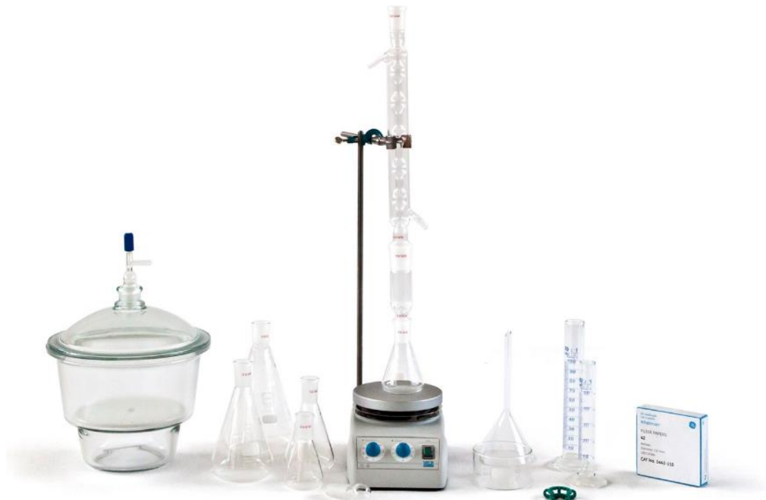
Εικόνα 5. Συνολική απεικόνιση ορισμένων συσκευών που χρησιμοποιήθηκαν για τον προσδιορισμό του ποσοστού των ασφαλτενίων
