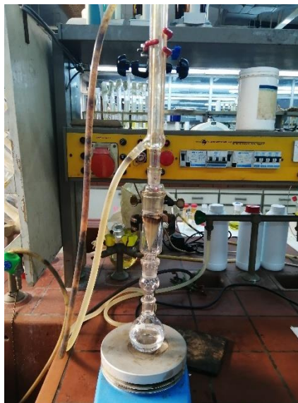
Εικόνα 8. Η διάταξη εκχύλισης με επτάνιο.
