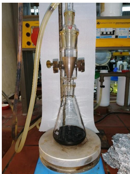
Εικόνα 9. Η διάταξη εκχύλισης με τολουόλιο.
