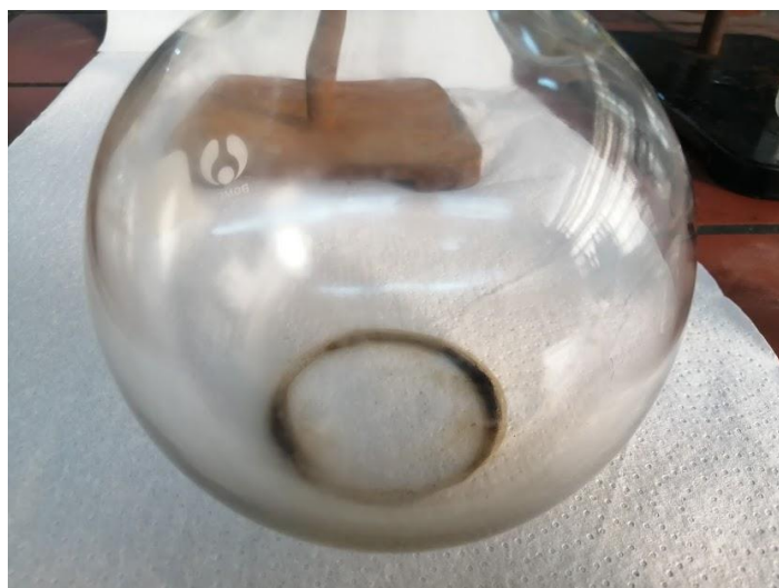
Εικόνα 22. Τα ασφαλτένια του vacuum gasoil που παρέμεναν στον πυθμένα της φιάλης μετά την απομάκρυνση του τολουόλιου με την μέθοδο της περιστροφικής εξάτμισης.
