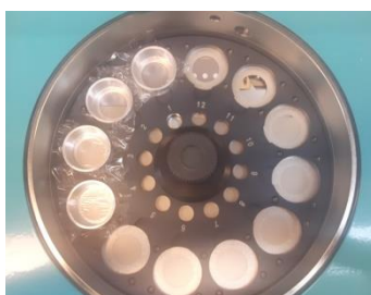
Εικόνα 16. Το εσωτερικό της συσκευής όπου τοποθετείται ο υποδοχέας με το δείγμα.
