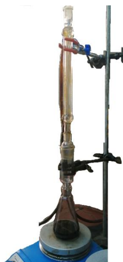
Εικόνα 6. Η διάταξη εκχύλισης όπως απαθανάτιστηκε στο εργαστήριο.
