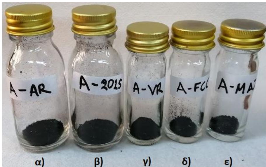
Εικόνα 21. Τα φιαλίδια με τα ασφαλτένια από: α) ατμοσφαιρικό υπόλειμμα (A-AR), β) διεργαστηριακό 2015 (A-2015), γ) υπόλειμμα κενού (A-VR), δ) FCC Slurry oil (A-FCC), ε) μαζούτ (A-MAZ).
