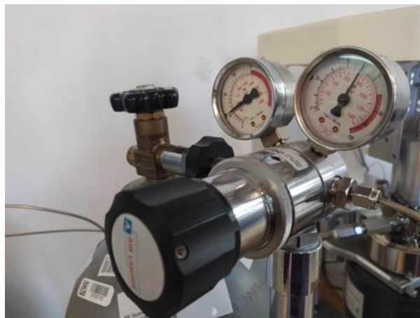
Εικόνα 22: Μειωτήρας στην κεφαλή της φιάλης του CO 2
