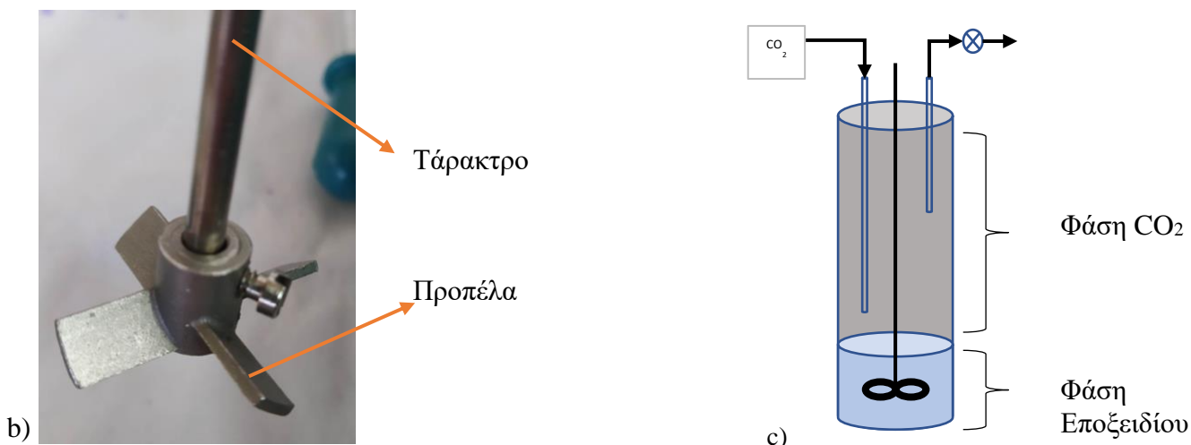
Εικόνα 23: a) Αντιδραστήρας Parr στον οποίο διεξάγεται η αντίδραση b) Τάρακτρο και προπέλα c) σχηματική αναπαράσταση αντιδραστήρα με τις φάσεις που υπάρχουν εσωτερικά. Ο καταλύτης είναι διαλυτοποιημένος στο εποξείδιο.
