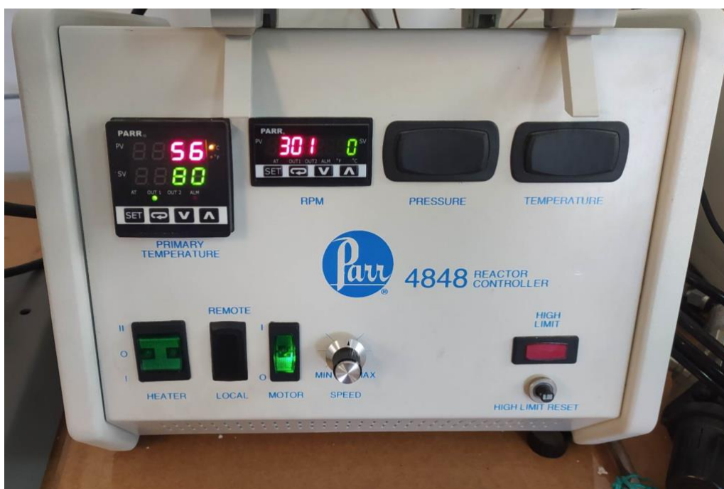
Εικόνα 24: Ελεγκτής (controller) του Parr αντιδραστήρα.
