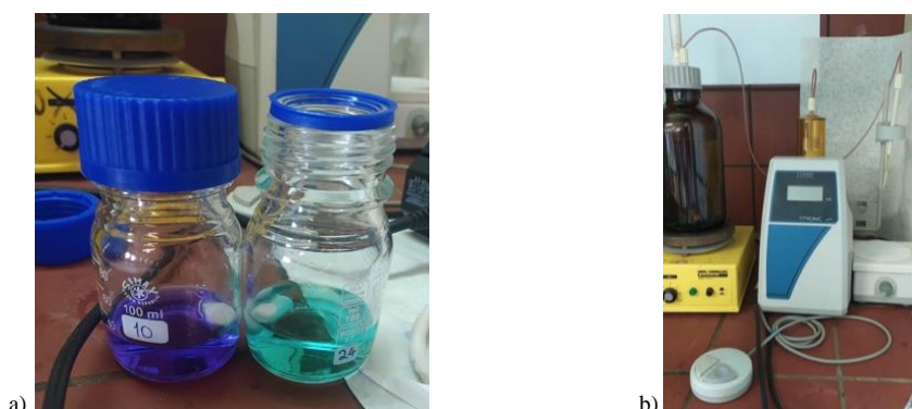
Εικόνα 25 a) Αριστερός δειγματολήπτης πριν την τιτλοδότηση δεξιός δειγματολήπτης στο τελικό σημείο της τιτλοδότησης, b) τιτλοδότης TITRONIC BASIC.
