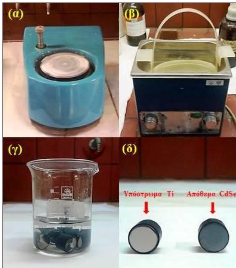
Σχήμα 5.5: α) Περιστρεφόμενος τροχός για τη λείανση των δοκιμίων, β) συσκευή υπερήχων, γ) εμβάπτιση των δοκιμίων σε συνήθεις διαλύτες για την εισαγωγή τους στους υπέρηχους, δ) δοκίμιο που φέρει πάνω του απόθεμα CdSe και δοκίμιο στο οποίο έχει ξεκινήσει η διαδικασία της λείανσης και φαίνεται το υπόστρωμα του Ti να αποκτά όψη καθρέφτη.
