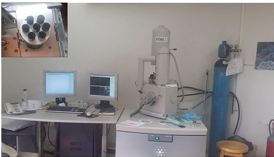
Εικόνα 5.5: Ηλεκτρονικό μικροσκόπιο σάρωσης (SEM, FEI Quanta 200) της Σχολής Χημικών Μηχανικών ΕΜΠ, με ενσωματωμένο αναλυτή διασποράς ακτίνων X (EDS). Πάνω αριστερά:
