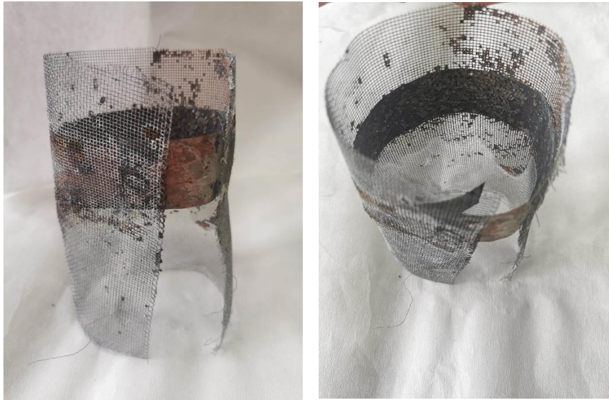
Εικόνα 36: Σταθεροποίηση τροποποιημένου πυριτίου σε χάλκινο έλασμα με carbon paint και συγκόλληση στο ανοξείδωτο πλέγμα.
