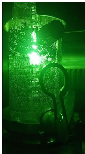
Εικόνα 37: αριστερά: αντιδραστήρας σε λειτουργία με πλέγμα πυριτίου, δεξιά: αποτελέσματα παραγωγής υδρογόνου.
