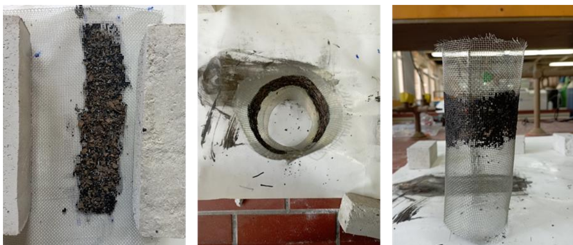
Εικόνα 35: Κατασκευή πλέγματος με carbon paint και 3 g τροποποιημένου πυριτίου.
