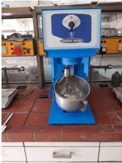
Εικόνα 23: αριστερά: μηχανήμα ανάδευσης τσιμέντου, δεξιά: τοποθέτηση διαλύματος ενεργοποίησης σε μήτρα.
