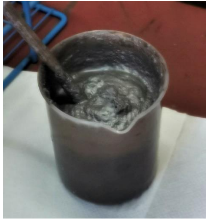
Εικόνα 29: Διάλυμα ανακτημένου Si-AgNO 3 -HF κατά την επιφανειακή προσβολή.
