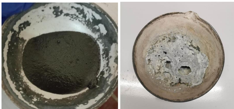
Εικόνα 47: αριστερά: μίγμα στερεού ενεργοποιητή πριν τη θερμική επεξεργασία, δεξιά: στερεός ενεργοποιητής πυριτικού νατρίου μετά τη θερμική επεξεργασία.
