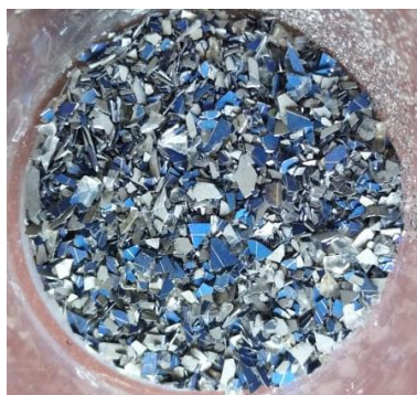
Εικόνα 27: Κομμάτια πυριτίου μετά την έκπλυση με νερό και ακετόνη.
