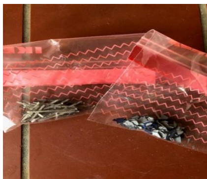
Εικόνα 26: Αποθήκευση ηλεκτροδίων χαλκού (αριστερά), πυριτίου (δεξιά) κατόπιν διαλογής.
