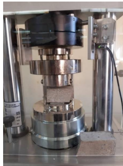
Εικόνα 24: Όργανο μέτρησης μηχανικών αντοχών, αριστερά: κάμψη, δεξιά: θλίψη.
