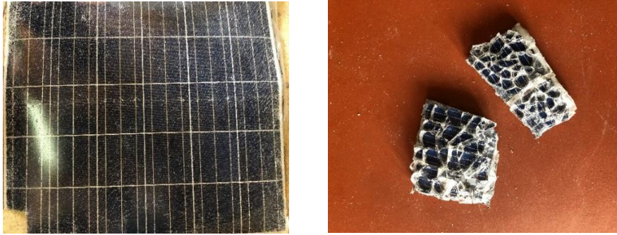
Εικόνα 13: αριστερά: φωτοβολταϊκό πάνελ πολυκρυσταλλικού πυριτίου, δεξιά: κομμάτια φωτοβολταϊκού πάνελ μετά τον τεμαχισμό.
