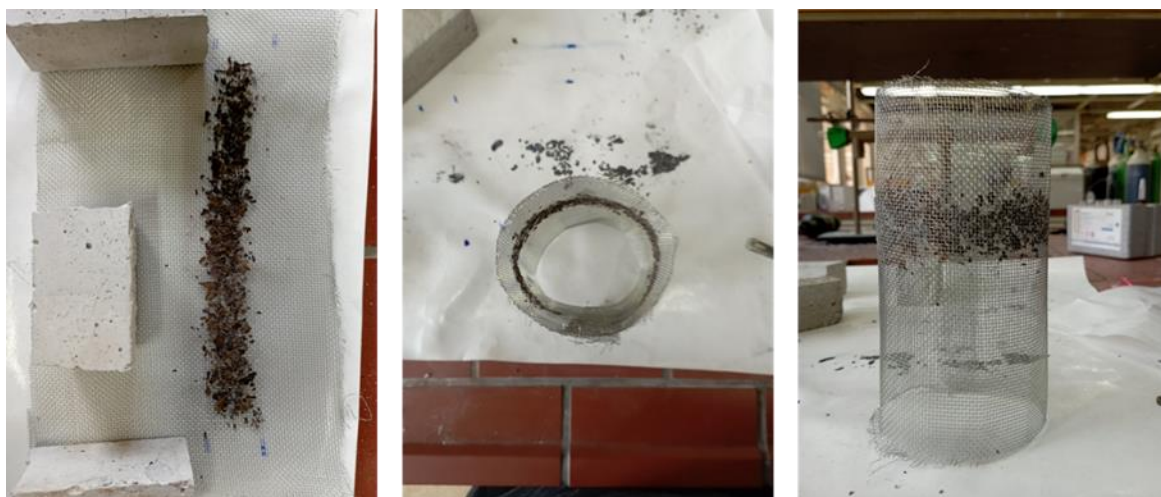
Εικόνα 34: Κατασκευή πλέγματος με κόλλα σιλικόνης και 3 g τροποποιημένου πυριτίου.
