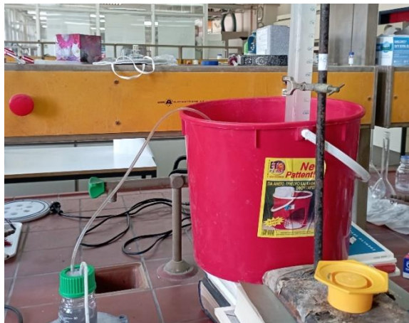
Εικόνα 21: Διάταξη αλκαλικής αντίδρασης πυριτίου: αριστερά: αρχική μορφή του διαλύματος κατά την προσθήκη Si, δεξιά: διάταξη αλκαλικής αντίδρασης και συλλογής αερίου.
