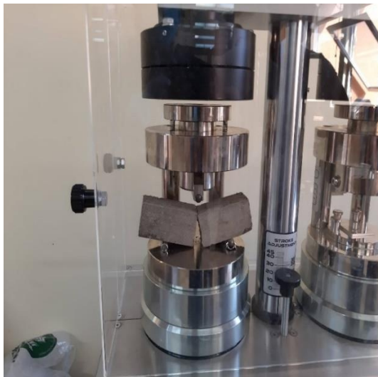
Εικόνα 24: Όργανο μέτρησης μηχανικών αντοχών, αριστερά: κάμψη, δεξιά: θλίψη.
