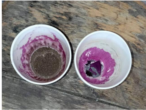
Εικόνα 32: Δείγματα ανακτημένου πυριτίου λειοτριβημένου με σφαιρόμυλο (αριστερά) και κρυσταλλικού πυριτίου (δεξιά), μετά τη σύνθεση με οξείδιο του κοβαλτίου.
