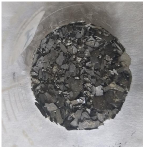
Εικόνα 30: Δείγμα ανακτημένου πυριτίου από φωτοβολταϊκά (αριστερά) και μονοκρυσταλλικού πυριτίου (δεξιά) μετά το etching με Ag.
