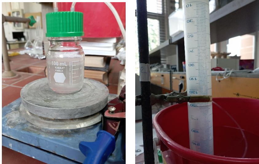
Εικόνα 38: αριστερά: διάλυμα πυριτικού νατρίου μετά το πέρας της αντίδρασης, δεξιά: παραγόμενη ποσότητα αερίου στον κύλινδρο.
