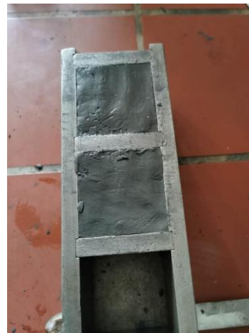
Εικόνα 23: αριστερά: μηχανήμα ανάδευσης τσιμέντου, δεξιά: τοποθέτηση διαλύματος ενεργοποίησης σε μήτρα.
