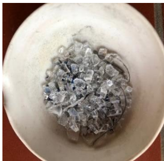
Εικόνα 25: Κομμάτι φωτοβολταϊκού πάνελ μετά την έψηση.
