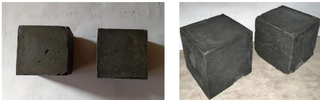
Εικόνα 46: Γεωπολυμερές ιπτάμενης τέφρας με διάλυμα ενεργοποίησης από ανακτημένο Si, μετά από 7 ημέρες σκλήρυνσης.
