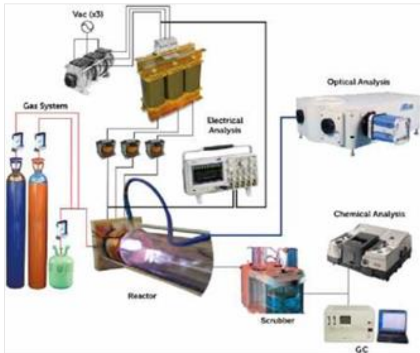
Εικόνα 4 Διάταξη για αποδόμηση ψυκτικών με πλάσμα 5
