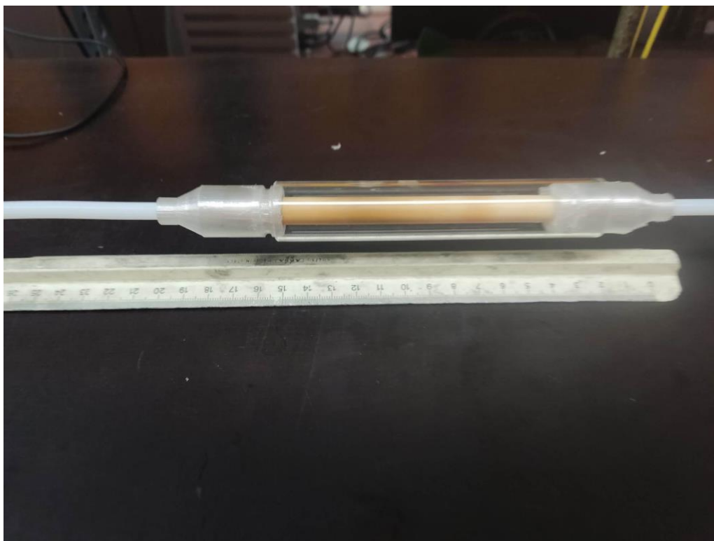
Εικόνα 10: Αντιδραστήρας dbd πριν την εφαρμογή πλάσματος
