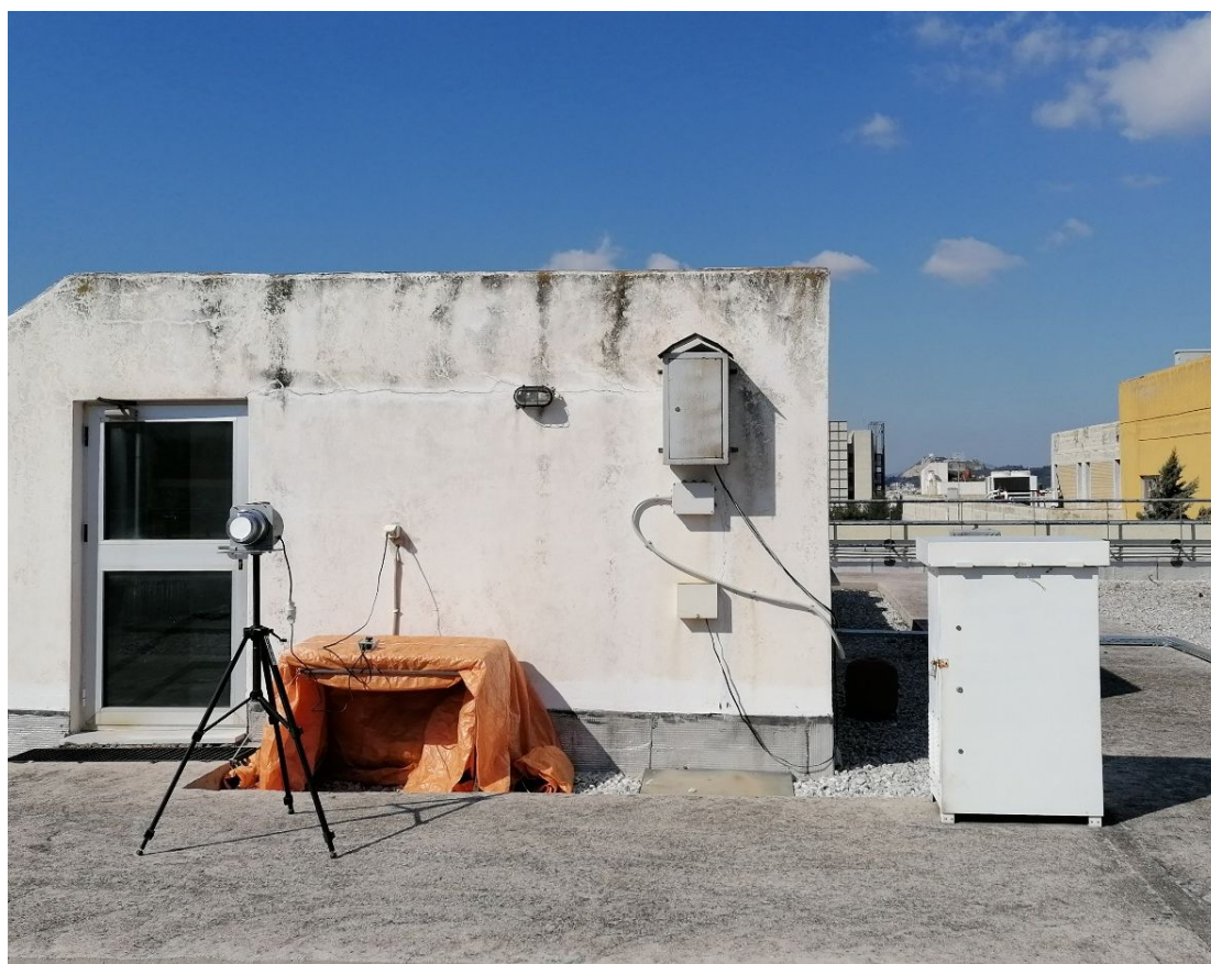
Σχήμα 4.3 : Η διάταξη των αντλιών του πειράματος. Αριστερά διακρίνεται η μικρή αντλία και δεξιά η μεγάλη στην οροφή του Κτιρίου Κ του ΕΠΤ-ΕΜΠ.
