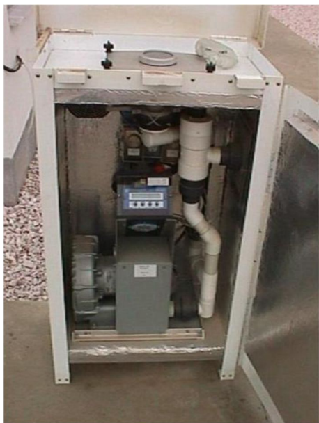
Σχήμα 2.4 : Οι αντλίες DH-50810E της F&J (αριστερά) και Staplex TFIA-2 (δεξιά)
