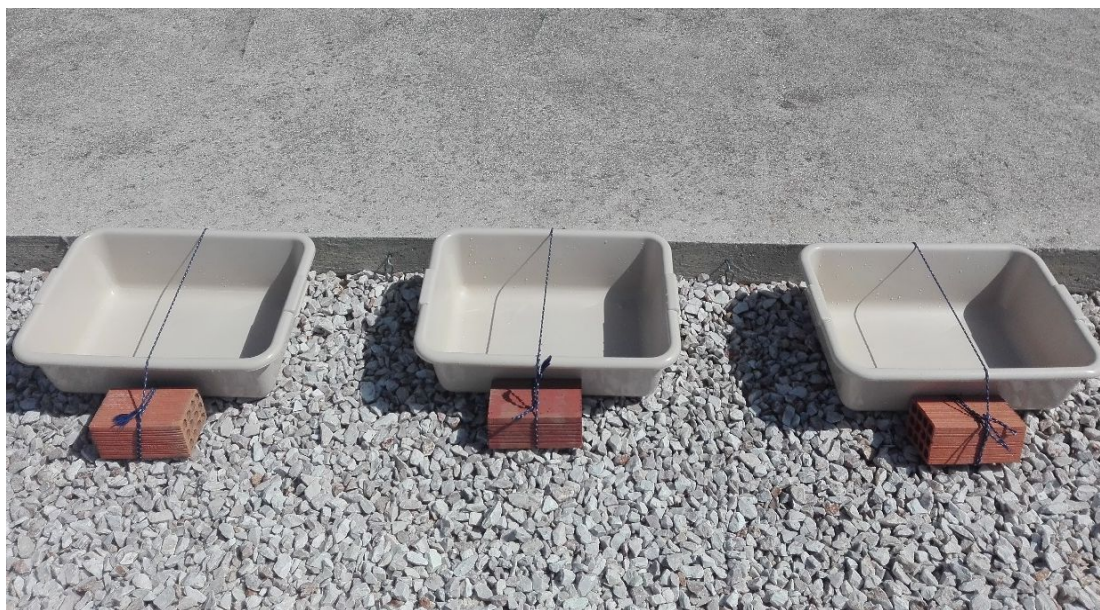
Σχήμα 5.1 : Πλαστικοί συλλέκτες για δειγματοληψία ατμοσφαιρικών αποθέσεων στην οροφή του Κτιρίου Κ του ΕΠΤ-ΕΜΠ
