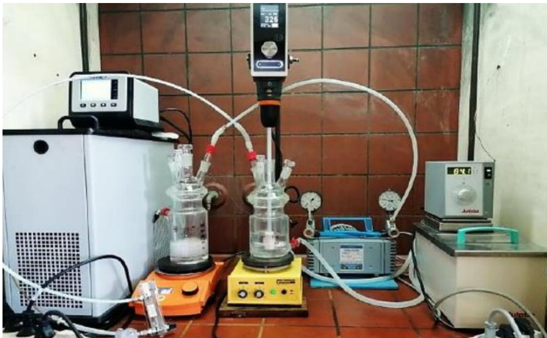
Εικόνα 28: Πειραματική διάταξη παραγωγής πολυμερών HEUR
