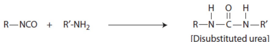
Εικόνα 7: Αντίδραση ισοκυανίου με αμίνη 12
