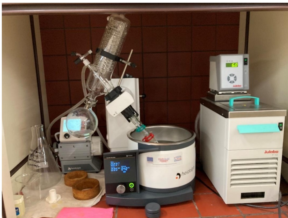
Εικόνα 19. Εξατμιστήρας για την απομάκρυνση αιθανόλης
