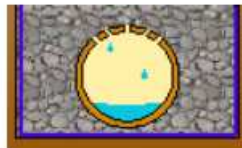
Εικόνα 4.5: Τομή διάτρητου σωλήνα (Drainage - Land Drainage for Fields and Gardens)
