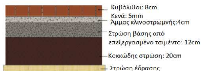
Εικόνα 5.6: Πλακόστρωτο οδόστρωμα ανάλυσης
