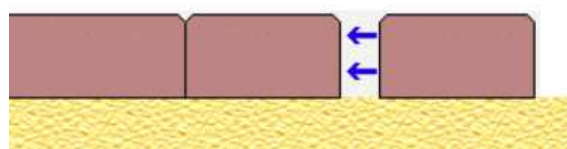
Εικόνα 4.26: Λανθασμένος τρόπος τοποθέτησης κυβόλιθων
