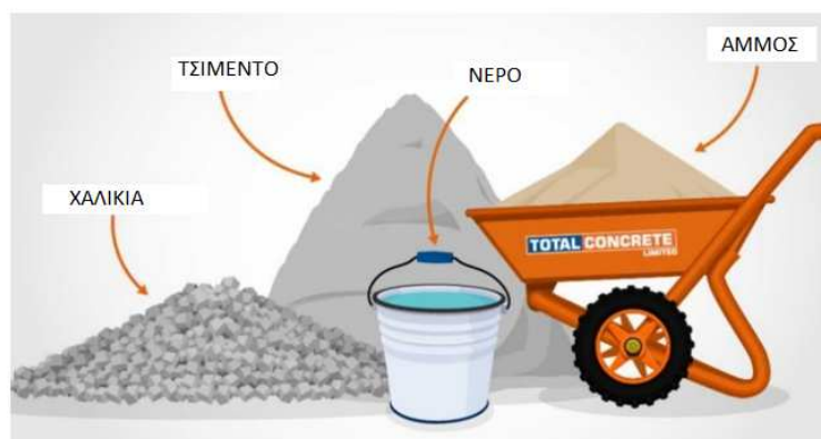
Εικόνα 3.3: Συστατικά κυβόλιθων σκυροδέματος
