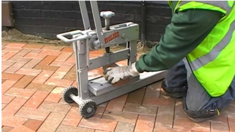
Εικόνα 4.28: Block splitter (από προσωπικό αρχείο)
