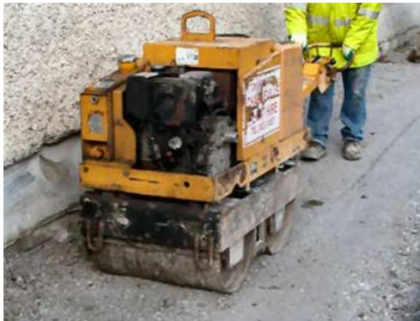
Εικόνα 4.18: Δονητικός συμπιεστής υλικού υπόβασης (Sub-bases)
