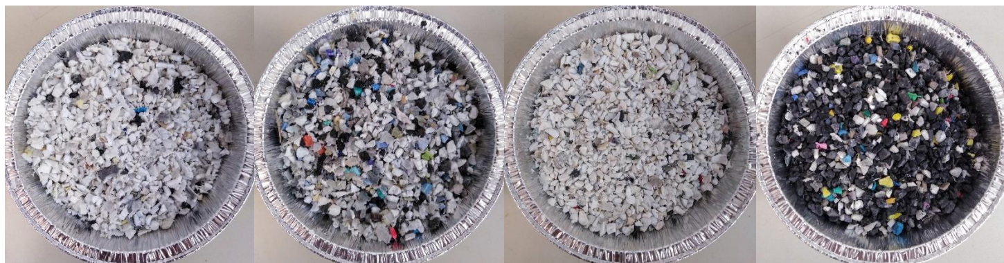
Εικόνα 5.1: Τα δείγματα μετά την άλεση. Από τα αριστερά προς τα δεξιά: CO-PP01RE-SO, CO-PP02RE-SO, CO-PP03RE-SO, CO-PP01SD-SO.
