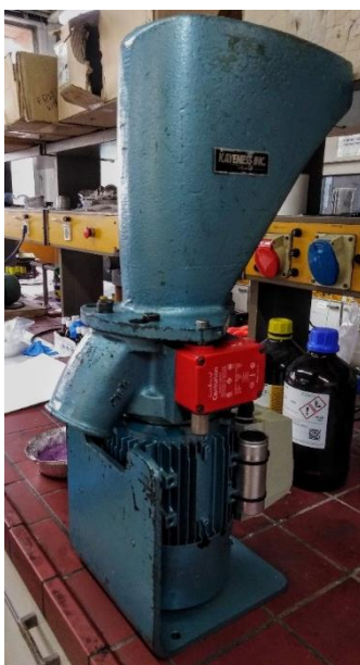
Εικόνα 4.2: Μύλος άλεσης MiniGran Dynisco.
