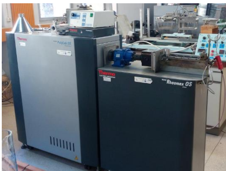
Εικόνα 4.4: Δικόχλιος εκβολέας HAAKE Rheomex PTW16.
