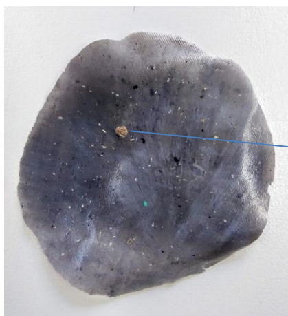
Εικόνα 5.3: Φιλμ του CO-PP02RE-SO με εμφανείς επιμολύνσεις.
