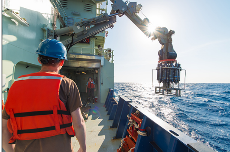
Εικόνα 26: Ο CTD πλευρικός γερανός του R/V Armstrong εν ώρα λειτουργίας
