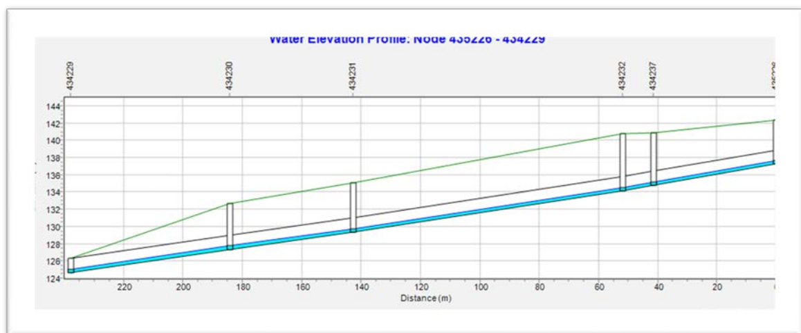
Εικόνα 4.8: Προφίλ αγωγών 1802, 1618 1619, 1620 και 1621 στο βαθμονομημένο μοντέλο κατά την χρονική στιγμή 00:40 (αιχμή υδρογραφήματος). Φαίνονται οι αγωγοί (μαύρο), το βάθος του νερού (μπλε), το άνω μέρος των αγωγών (μαύρο), η πιεζομετρική γραμμή (μωβ) η επιφάνεια του εδάφους (πράσινο) και τα φρεάτια (κατακόρυφες γραμμές).
