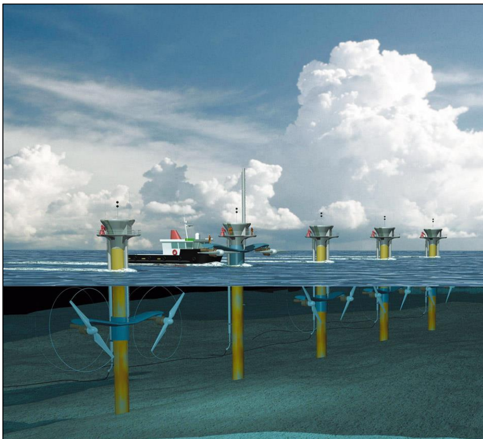
Εικόνα 8: Ψηφιακή αναπαράσταση μιας σειράς στροβίλων αξονικής ροής [22]
