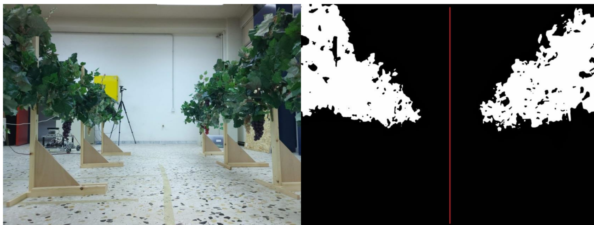
Σχήμα 4-16. Στιγμιότυπο της κάμερας του ρομπότ και η αντίστοιχη τμηματοποιημένη εικόνα όταν έχει ισαπέχουσες αποστάσεις από τα αμπέλια και ουδέτερο προσανατολισμό.
