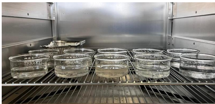
Σχήμα 17: Κρυσταλλωτήρια με υδατικό διάλυμα χιτοζάνης-NaDES στον φούρνο προς σχηματισμό φιλμ
