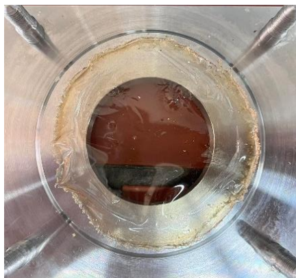
Σχήμα 21: Φιλμ τοποθετημένο στη πλάκα στήριξης
