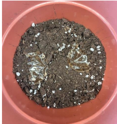
Σχήμα 26: Δείγματα φιλμ σε βάθος 6 cm προς μελέτη βιοαποικοδομησιμότητας
