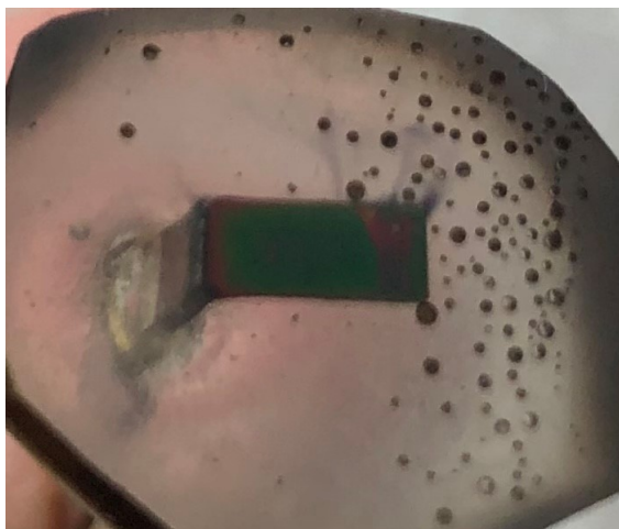
Σχήμα 2.4: Φιλμ οξειδίων του μαγγανίου σε επιφάνεια χάλυβα με γαλβανοστατική απόθεση αναγωγικού ρεύματος -50 \mu\text{A} .
