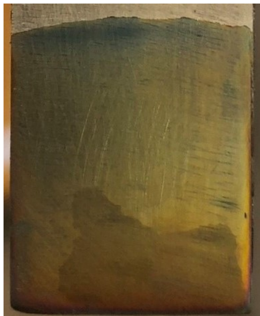
Σχήμα 3.3: Ποτενσιοστατική απόθεση οξειδίων του μολυβδαινίου σε επιφάνεια χάλυβα με επιβολή -0.8\text{ V} για 30\text{ s} με αναγωγή μολυβδαινικών ανιόντων υδατικού διαλύματος \text{Na}_2\text{MoO}_4 0.04\text{ M} και \text{H}_2\text{SO}_4 0.01\text{ M} .
