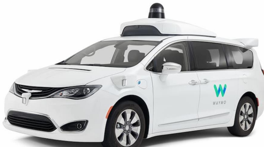
Εικόνα 49 - Αυτόνομο όχημα Chrysler Pacifica Minivan – Το πρώτο αυτόνομο όχημα που κυκλοφόρησε μαζικά για εμπορικούς σκοπούς στους δρόμους των ΗΠΑ – Στην οροφή του ξεχωρίζει εμφανώς η συσκευή LiDAR που είναι βασικός πυλώνας επίτευξης της αυτόνομης κίνησής του και η λειτουργία της θα αναλυθεί εκτενώς παρακάτω. (WAYMO)
