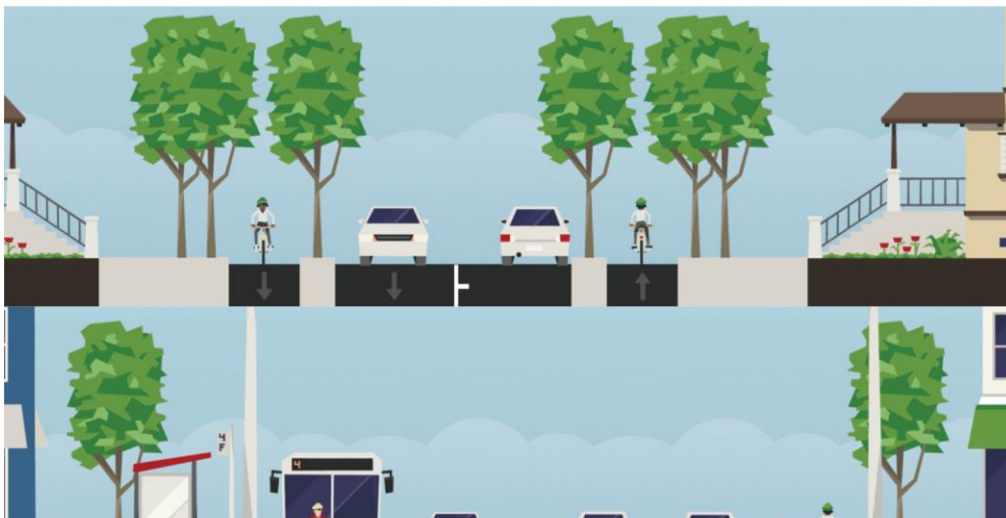
Εικόνα 53 - (κάτω) τυπική διατομή οδού με τις ισχύουσες διαστάσεις σχεδίασης – (πάνω) ενδεικτική τυπική διατομή οδού βάσει σχεδίασης για κυκλοφορία αμιγώς αυτόνομων οχημάτων (Riggs, Ruhl, Rodier, & Baumgardener, 2019)
