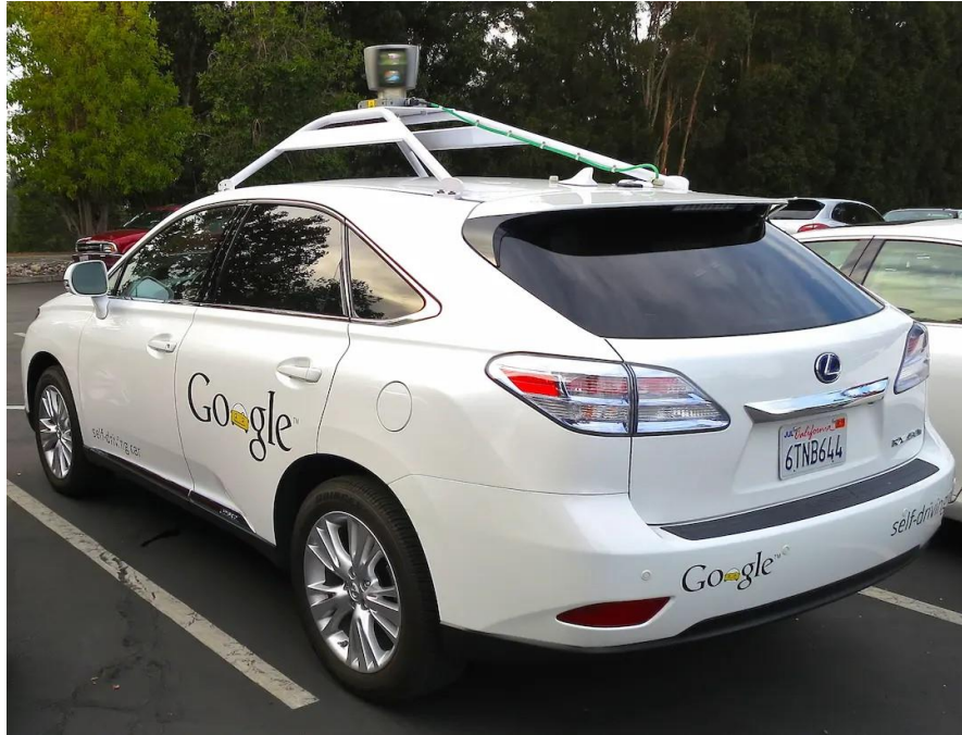
Εικόνα 51 - Συσκευή LiDAR τοποθετημένη στην οροφή ενός από τα πρώτα πειραματικά αυτόνομα οχήματα Lexus RX450h της Google
