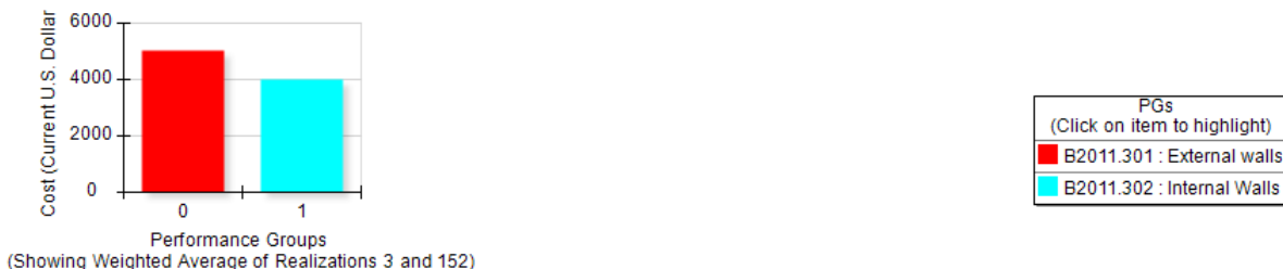
Σχήμα 4.27: Συνεισφορά κατηγοριών των δομικών και μη στοιχείων στο σενάριο σεισμικής διέγερσης με πιθανότητα υπέρβασης 74% στα 50 χρόνια
