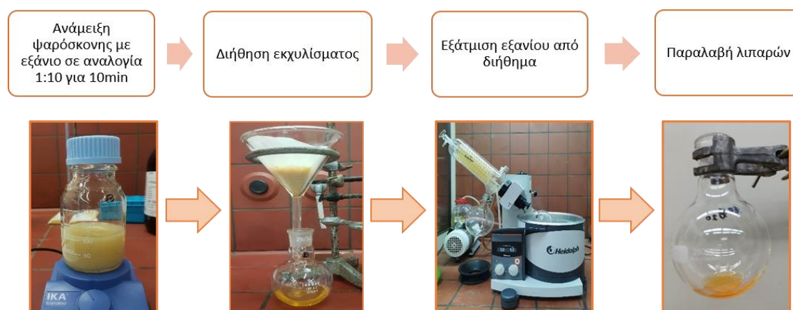
Σχήμα 4.2: Διάγραμμα ροής παραλαβής λιπαρών από ψαρόσκονη.
