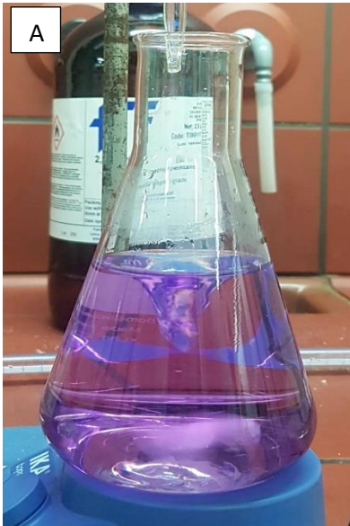
Εικόνα 4.3: Διάλυμα αμμωνίας και θειικού οξέος παρουσία δείκτη ερυθρό του μεθυλίου (A) πριν (B) μετά από τιτλοδότηση με καυστικό νάτριο 0,5N.
